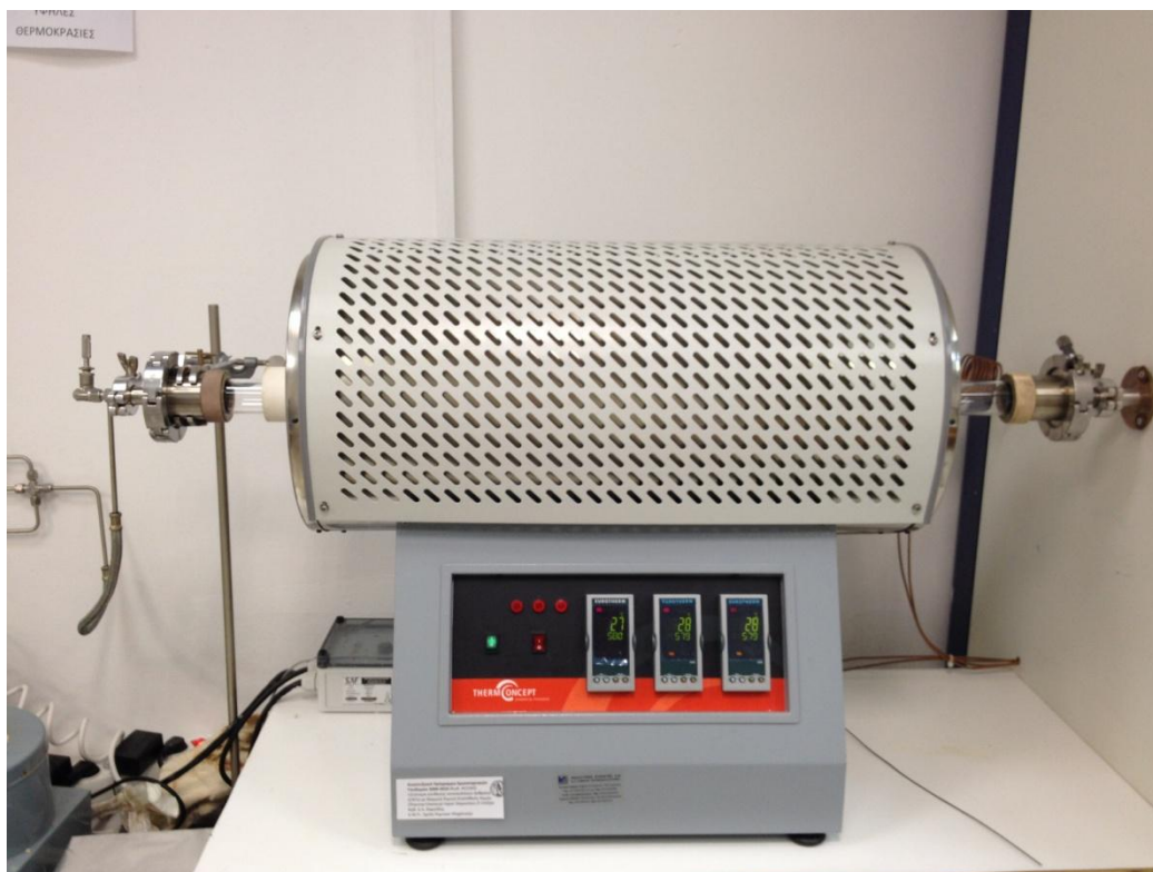
Εικόνα 26. Πειραματική διάταξη που χρησιμοποιήθηκε για τη θερμική χημική εναπόθεση ατμών (TCVD) υδρογονανθράκων προς παραγωγή νανοσωλήνων άνθρακα
