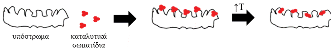
Εικόνα 17. «Αλληλεπιδράσεις» μεταξύ υποστρώματος και καταλυτικών σωματιδίων
