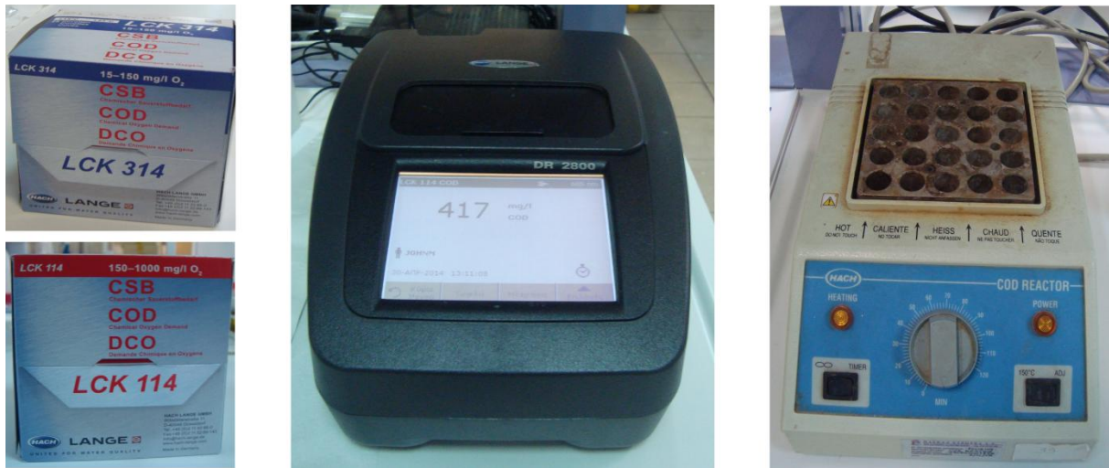
Σχήμα 3.6 Αντιδραστήρια Hach για τον προσδιορισμό COD (αριστερά), φασματοφωτόμετρο (κέντρο) και χωνευτής (δεξιά)
