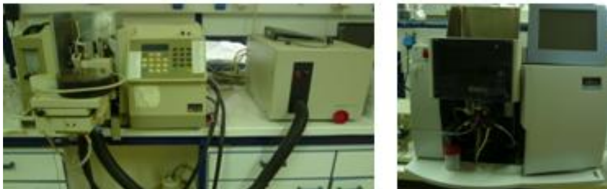
Σχήμα 3.9 Φούρνος γραφίτη AAS Perkin Elmer 3110/HGA600 (αριστερά) και AAS φλόγας Perkin Elmer Analyst 200 (δεξιά)
