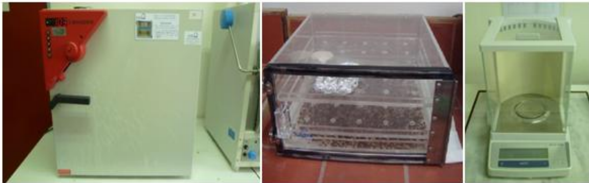
Σχήμα 3.3 Προσδιορισμός ολικών στερεών με τη χρήση φούρνου 103°C (αριστερά), ξηραντήρα (κέντρο) και ζυγού ακριβείας (δεξιά)
