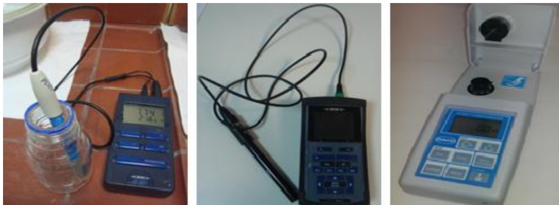
Σχήμα 3.7 pH-μετρο WTW (αριστερά), αγωγιμόμετρο WTW (κέντρο) και θολόμετρο Hach 2100P (δεξιά)
