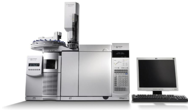
Σχήμα 3.11 Αέριος χρωματογράφος Agilent 7890A συζευγμένος με φασματογράφο μάζας Agilent 5975C
