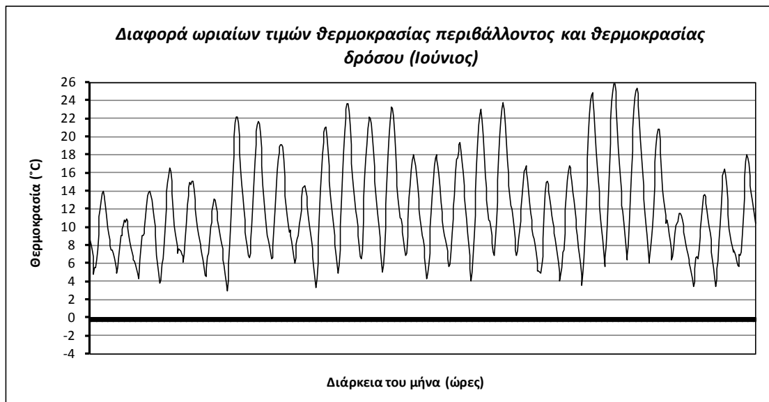
Διάγραμμα Α/Δ.6. Διαγραμματική απεικόνιση της διαφοράς ανάμεσα στη θερμοκρασία αέρα στο εξωτερικό περιβάλλον και στην αντίστοιχη θερμοκρασία δρόσου κατά το μήνα Ιούνιο (πηγή: πρωτότυπη)
