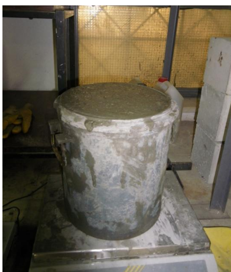
Εικόνα 23: Ζύγιση πληρωμένου δοχείου μέτρησης καθαρού βάρους
