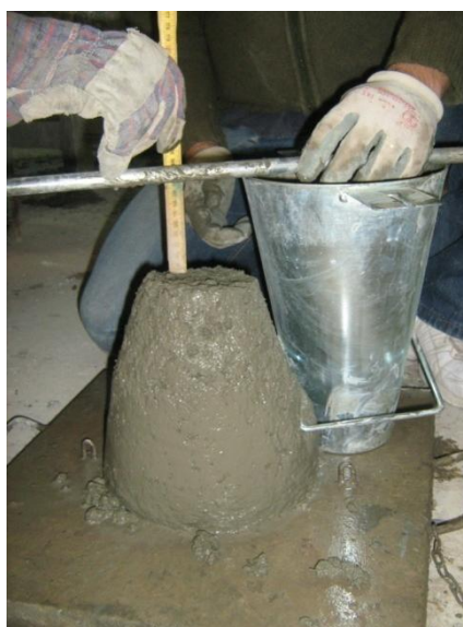
Εικόνα 21: Μέτρηση κάθισης νωπού σκυροδέματος
