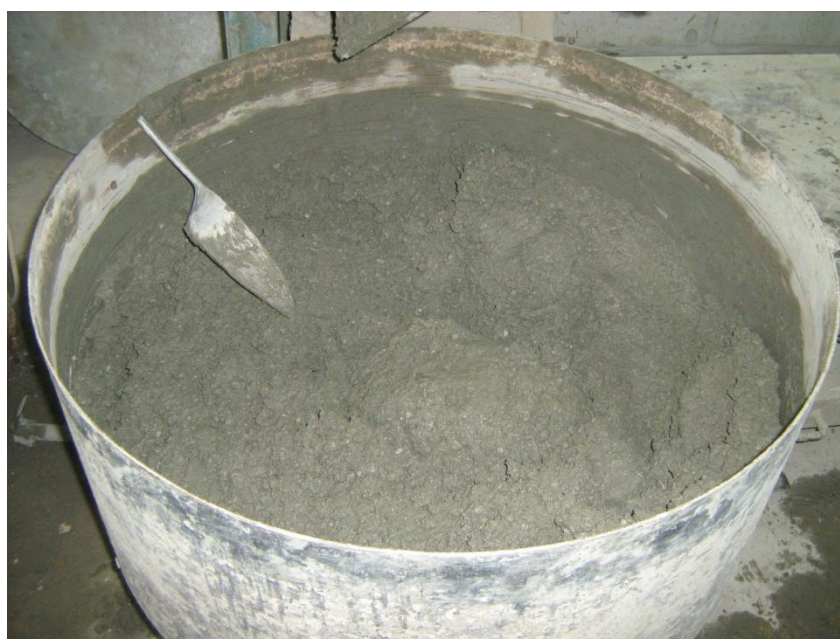
Εικόνα 20: Τελικό μείγμα μετά και την προσθήκη των ινών, της πυριτικής παιπάλης και του ρευστοποιητή
