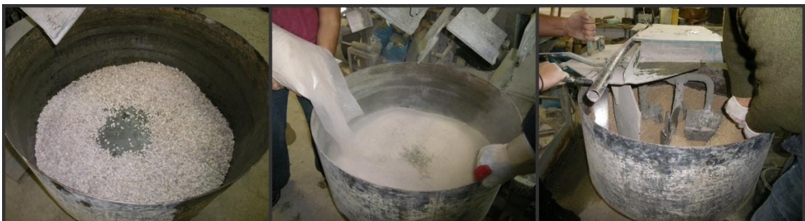
Εικόνα 18: Προσθήκη αδρανών υλικών, ποσότητας νερού και ανάδευση
