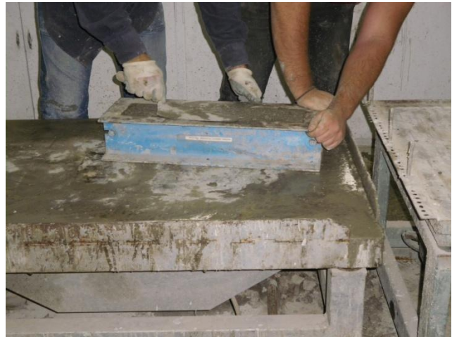
Εικόνα 24: Δόνηση πρισματικής μήτρας στην τράπεζα δόνησης
