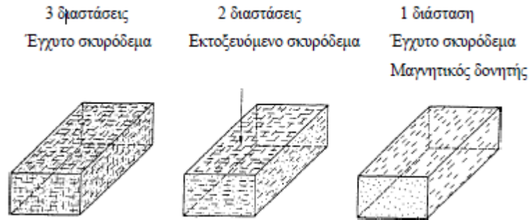
Εικόνα 10: Πιθανοί προσανατολισμοί των ινών στο σκυρόδεμα (Maidl, 1995)
