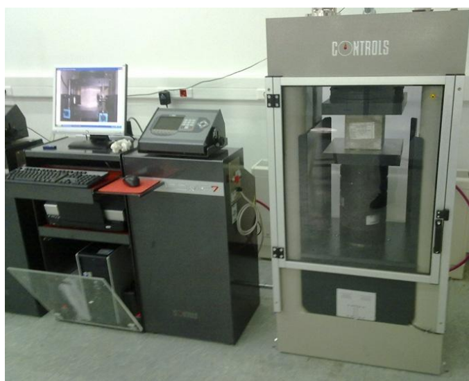
Εικόνα 26: Πλαίσιο κάμψης δυναμικότητας φόρτισης 150kN και δοκιμών θλίψης δυναμικότητας 5000kN και μονάδα ελέγχου τριαξονικών δοκιμών Sercomp 7
