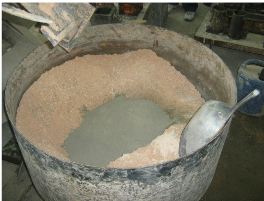
Εικόνα 19: Προσθήκη τσιμέντου και υπόλοιπης ποσότητας νερού και συνέχιση της ανάδευσης του μείγματος
