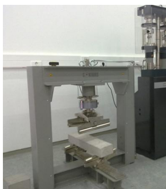
Εικόνα 26: Πλαίσιο κάμψης δυναμικότητας φόρτισης 150kN και δοκιμών θλίψης δυναμικότητας 5000kN και μονάδα ελέγχου τριαξονικών δοκιμών Sercomp 7
