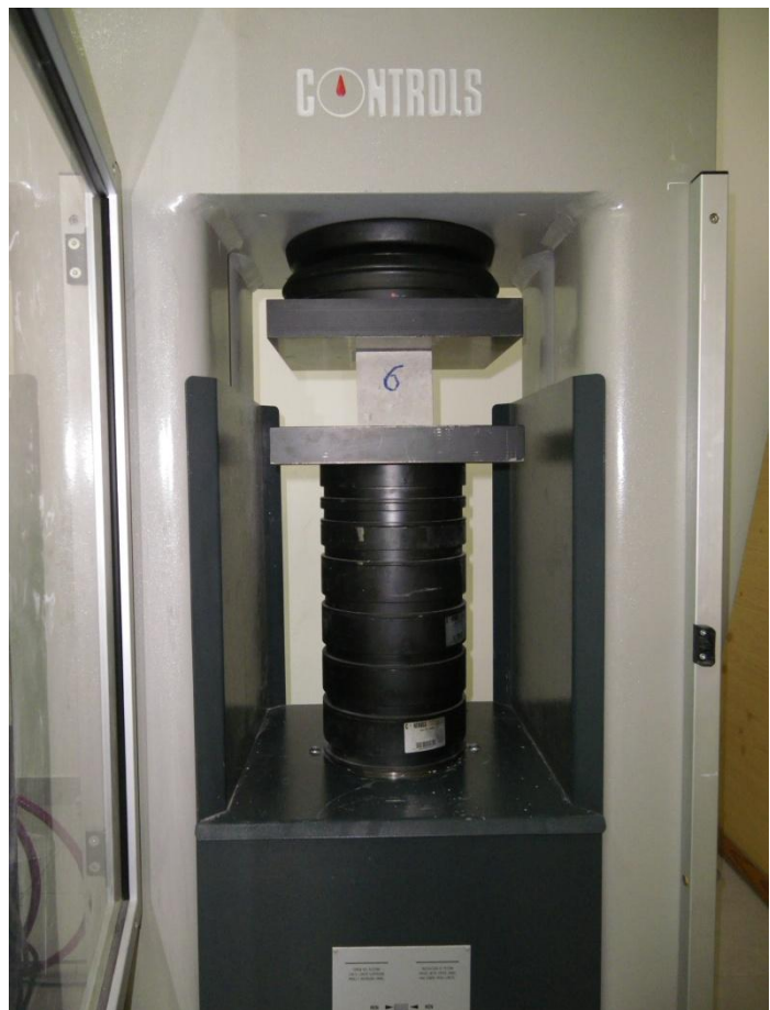
Εικόνα 27: Θλίψη κυβικού δοκιμίου
