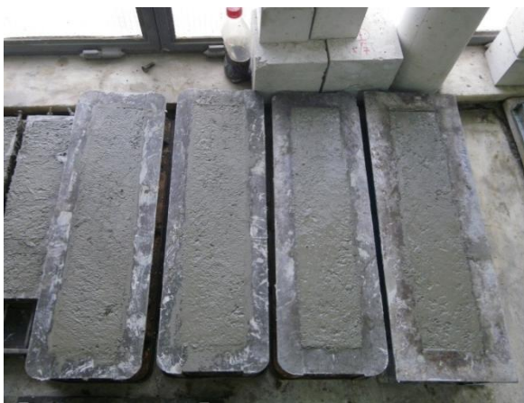
Εικόνα 25: Πρισματικές και κυβικές μήτρες πληρωμένες με σκυρόδεμα
