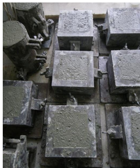
Εικόνα 25: Πρισματικές και κυβικές μήτρες πληρωμένες με σκυρόδεμα
