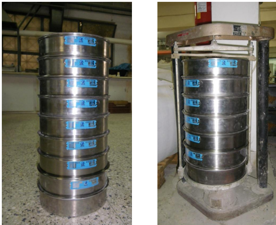
Εικόνα 15: Σειρά κοσκίνων και συσκευή κοσκινίσματος
