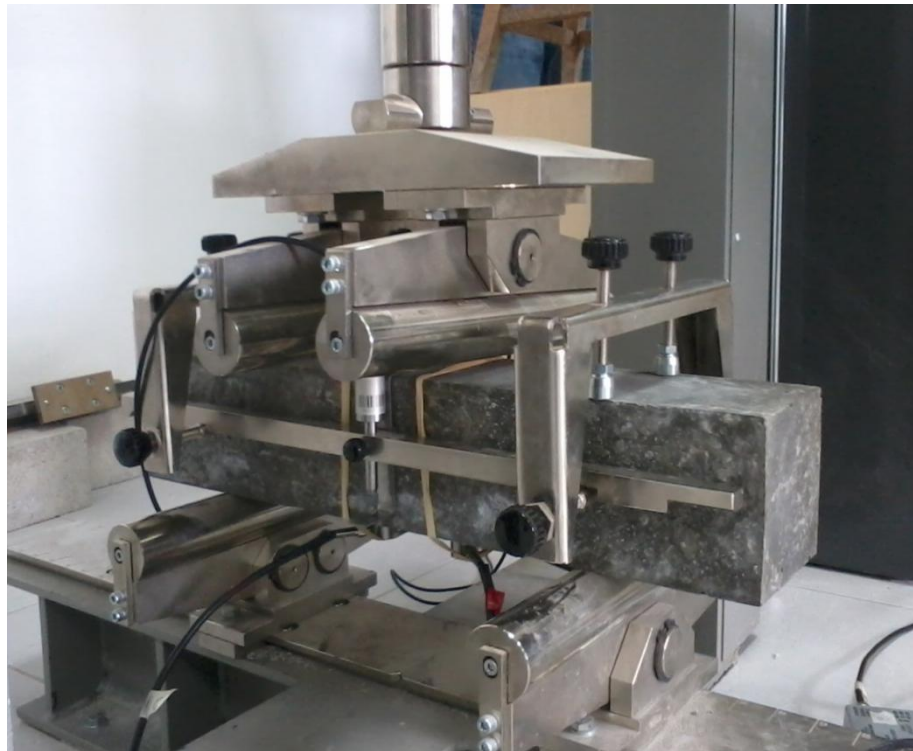
Εικόνα 30: Διάταξη δοκιμής κάμψης 4 σημείων
