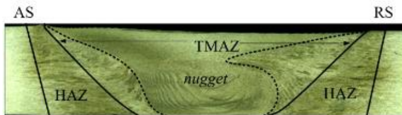
Σχήμα 2-7: Μικρογραφία κάθετης τομής της FSW [9]
