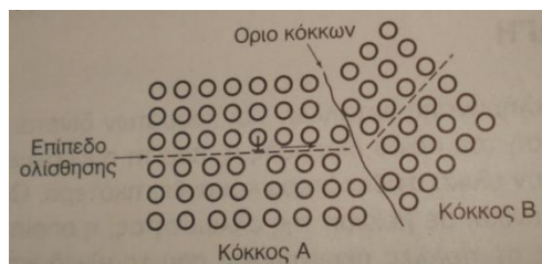
Σχήμα 3-3: Σχηματική αναπαράσταση της μετακίνησης μίας διαταραχής διαμέσου περατωτικού ορίου δύο κόκκων, διαφορετικών προσανατολισμών. Τα επίπεδα ολίσθησης παρουσιάζουν ασυνέχεια και αλλάζουν διεύθυνση εκατέρωθεν του περατωτικού ορίου, το οποίο επενεργεί ως εμπόδιο στη μετακίνηση της διαταραχής [2]
