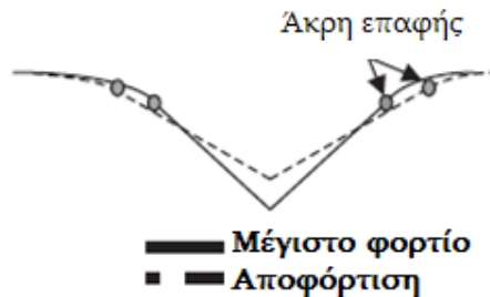
Σχήμα 4-6: Μεταβολή της επιφάνειας επαφής μετά την αποφόρτιση
