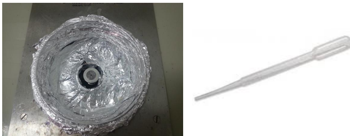
Εικόνα 6.1: Αριστερά spin coater, δεξιά πιπέτα
