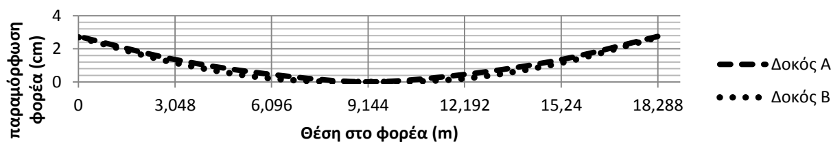
Διάγραμμα 38: Παραμορφώσεις δοκών λόγω ίδιου βάρους μετά από προσαρμογή
