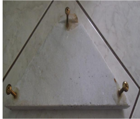
Φωτογραφία 19:Σημεία Στήριξης Έδρας Ελέγχου
