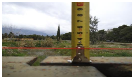
Φωτογραφία 24: Βέλος κάμψης με τη χρήση νήματος
