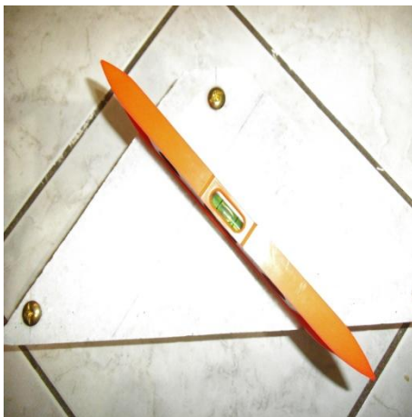
Φωτογραφία 20:Οριζοντίωση Έδρας Ελέγχου
