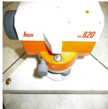
Φωτογραφία 21:Οριζοντίωση με τη χρήση της στάθμης χωροβάτη
