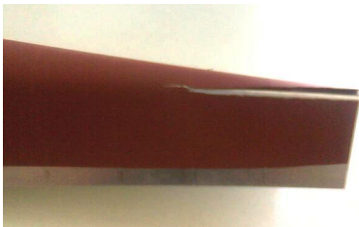
Σχήμα 3.19: Χαρακτηριστικά παραδείγματα επικαλύψεων (αστάρια μετάλλων) που παρουσιάζουν ρηγματώσεις και αποκόλληση από το υπόστρωμα μετά τη δοκιμή της αντοχής σε κάμψη [70] .
