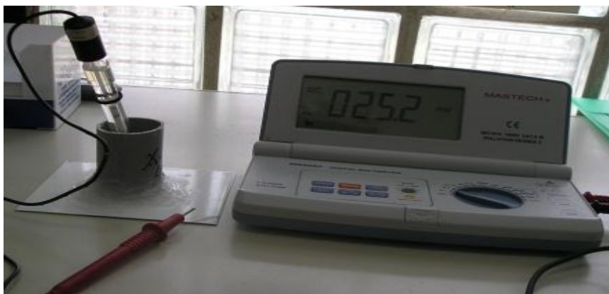
Εικόνα 6.1: Η συνδεσμολογία που χρησιμοποιήθηκε και το ψηφιακό πολύμετρο τύπου Mastech MS 8207
