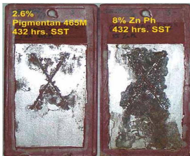
Εικόνα 5.1: Συγκριτικά δοκίμια 2.6% Pigmentan 465M και 8% Zinc Phosphat μετά από 432 ώρες σε NaCl περιβάλλον [44].
