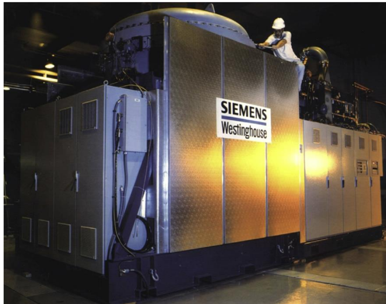
Σχήμα 2.1 Υβριδικό σύστημα ΚΚ – Αεριοστροβίλου, ισχύος 220 kW, από τη Siemens-Westinghouse [65].
