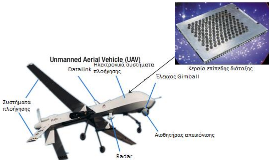
Σχήμα 3.11 : Δομή και κύρια χαρακτηριστικά ενός UAV
