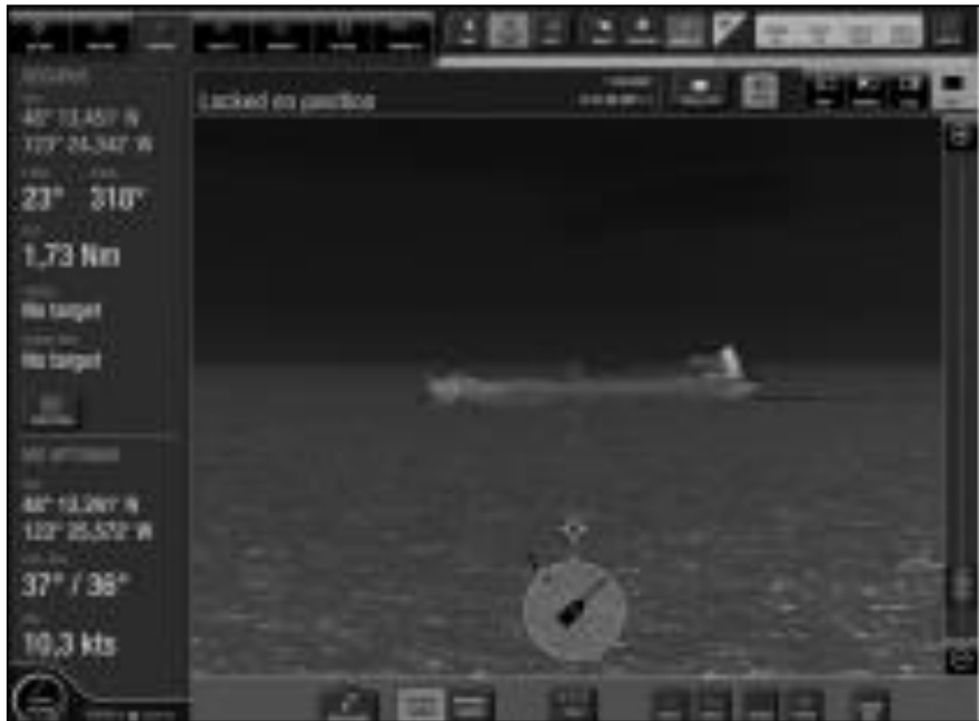
Σχήμα 3.21 : Απεικόνιση πραγματικού χρόνου βασισμένη στην τεχνολογία SONAR
