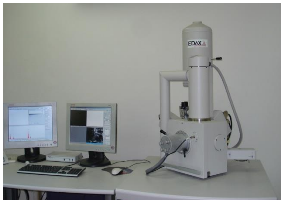
Εικόνα 4.8: Κύκλωμα EDS και SEM της εταιρίας FEI-QUANTA 200.
