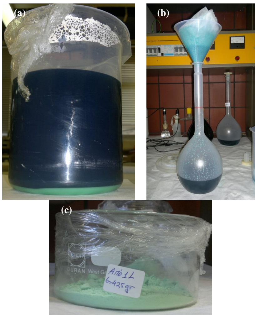
Εικόνα 4.4: a) Ηλεκτρολύτης- ίζημα, b) διήθηση ηλεκτρολύτη, c)περισυλλογή ιζήματος.
