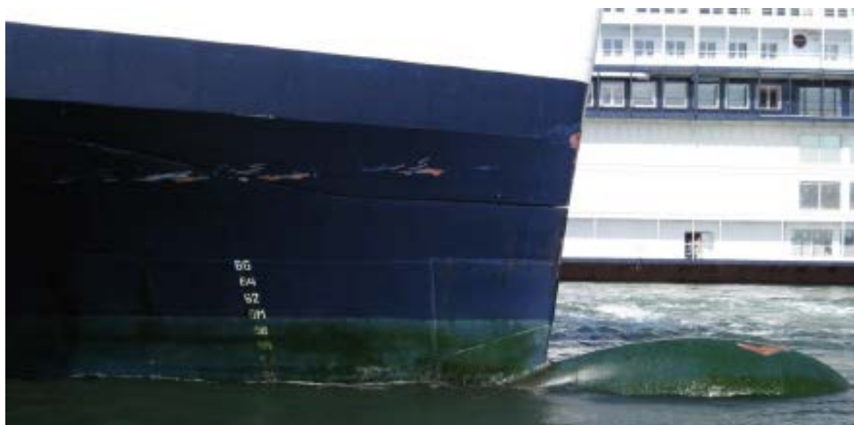
Εικόνα 3.2: Ατύχημα ID 44, η επιφανειακή βλάβη στην πλώρη του πλοίου RoPax.
