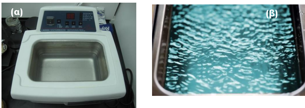
Εικόνα 14: Τυπική διάταξη λουτρού υπερήχων (α). Διακρίνεται το λουτρό και το τροφοδοτικό για τις ρυθμίσεις του χρόνου και της έντασης των κυμάτων που παράγονται από τη μηχανική δόνηση. Στην φωτογραφία (β) διακρίνονται τα επιφανειακά κύματα που δημιουργούνται
