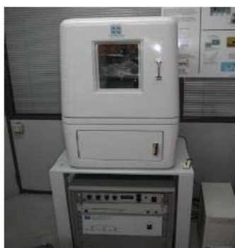
Εικόνα 7.6: Διάταξη Νανοδιείσδυσης Hysitron TriboLab
