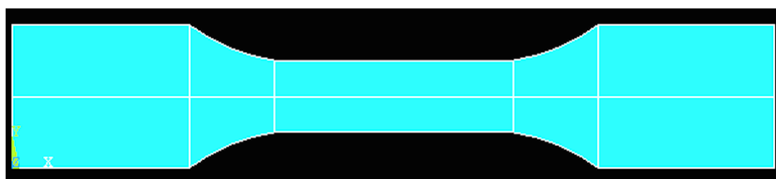
Εικόνα 8.61: Δοκίμιο με δυο περιοχές μηχανικών ιδιοτήτων
