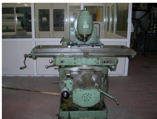
Εικόνα 7.1: Διάταξη μηχανής συγκόλλησης δια τριβής μέσω ανάδευσης.
