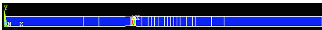
Εικόνα 8.39: εκτέλεση πειράματος εφελκυσμού συγκολλημένων κραμάτων αλουμινίου στο Ansys όπου λαμβάνουμε υπόψη τις διαφορετικές ιδιότητες (Μέτρο Ελαστικότητας και όριο διαρροής) για 21 περιοχές οι οποίες περιλαμβάνουν τις ζώνες των μετάλλων βάσης BM1 & BM2, των θερμικά επηρεασμένων ζωνών HAZ1 & HAZ2, των θερμομηχανικά επηρεασμένων ζωνών TMAZ1 & TMAZ2 των ζωνών συγκόλλησης WZ1 & WZ2.
