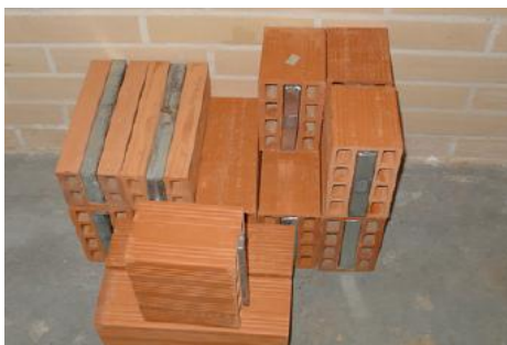
Εικόνα 4.2.1.3.2.1: Τούβλα με PCM σε μακροκάψουλες [36]
