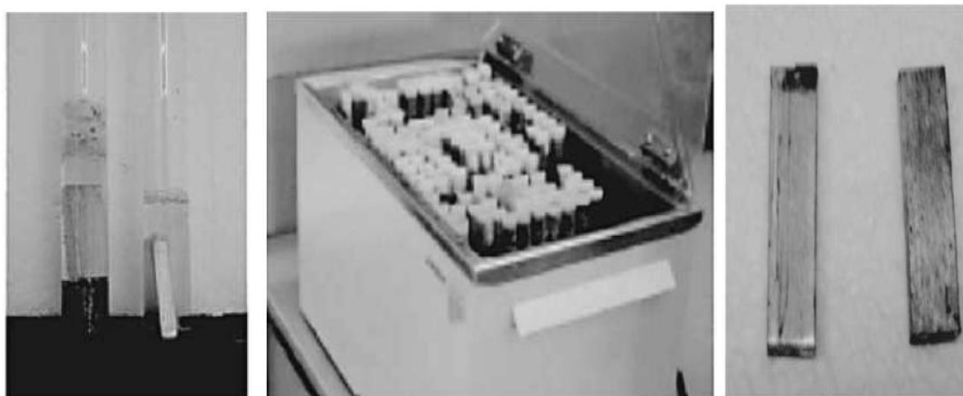
Εικόνα 3.4.5.1: Στάδια πειράματος συμβατότητας ανόργανων PCM με διάφορα υλικά
