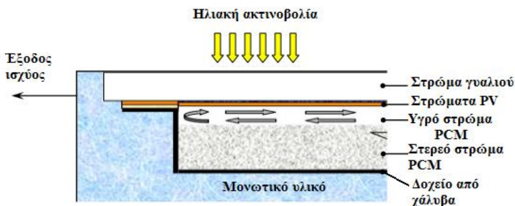
Εικόνα 4.2.2.6.2: Τμήμα του PV/PCM [102]
