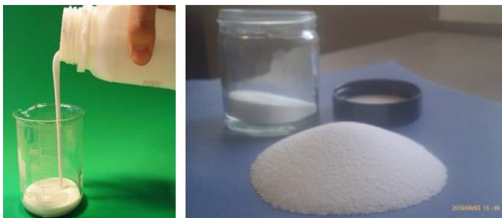
Εικόνα 3.5.1.2.2: PCM slurry (αριστερά) και περίπτωση μικροενσωμάτωσης PCM σε μορφή σκόνης (Micronal powder της εταιρείας BASF)(δεξιά)
