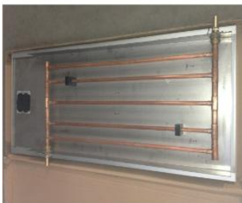
Εικόνα 4.2.2.6.3: Σωληνώσεις νερού εντός του δοχείου
