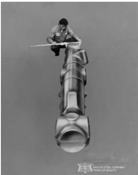
Εικόνα 27: α) Τμήμα β) σχεδιάγραμμα του κύριου σκέλους προσγείωσης του Boeing777 που κυρίως χρησιμοποιεί σφυρήλατα τμήματα Ti-10V-2Fe-3Al
