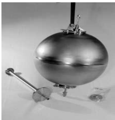
Εικόνα 33 δεξαμενή που χρησιμοποιείται για το γυροσκοπικό σύστημα ελέγχου ( SCA ) στους πυραύλους Ariane 5 .
