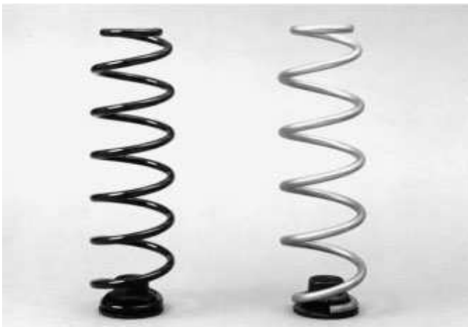
Εικόνα 22 ελατήρια αναρτήσεων του πίσω άξονα του Lupo FSI (δεξιά χάλυβας, αριστερά, δεξιά κράμα LCB)
