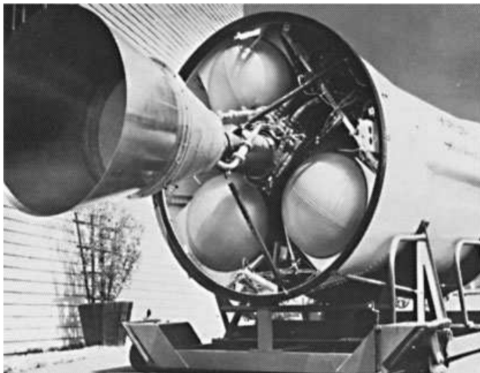
Εικόνα 32 δεξαμενές πίεσης που κατασκευάζονται από τιτάνιο για διαστημικές μεταφορές
