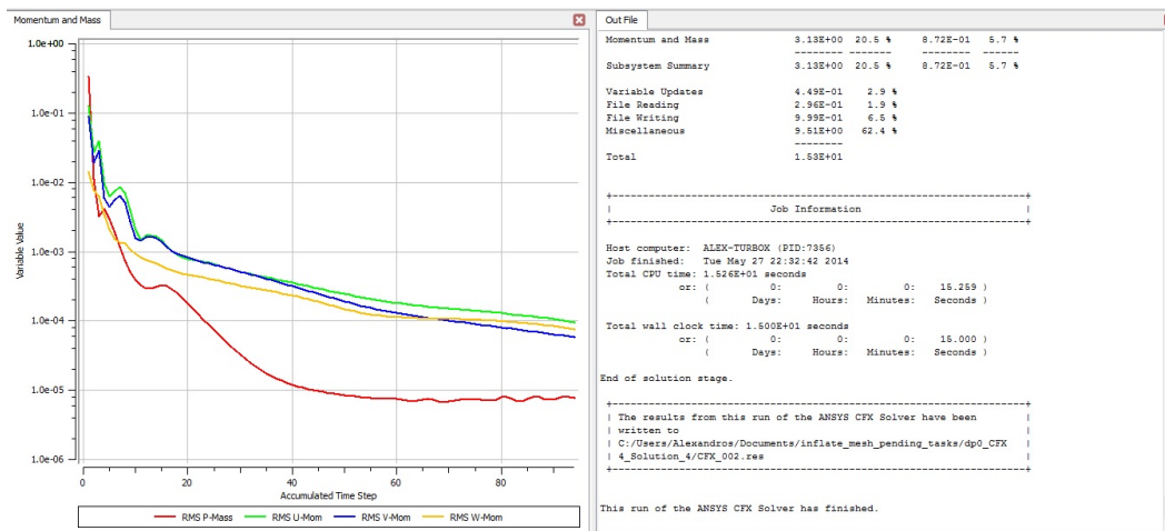
Σχήμα 5.14: Καμπύλη σύγκλισης του Ansys Solver. Με κόκκινο χρώμα είναι η RMS τιμή της μάζας και οι υπόλοιπες είναι οι RMS τιμές των συνιστωσών της ταχύτητας. Στον κάθετο άξονα φαίνεται η παράμετρος της απόκλισης και στον οριζόντιο τα run που απαιτήθηκαν για τη σύγκλιση.
