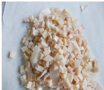
Εικόνα 3.7: Κομμένο δείγμα PBS ορθογώνιου πλακιδίου σε μικρότερο μέγεθος, με τη χρήση πριονιού.
