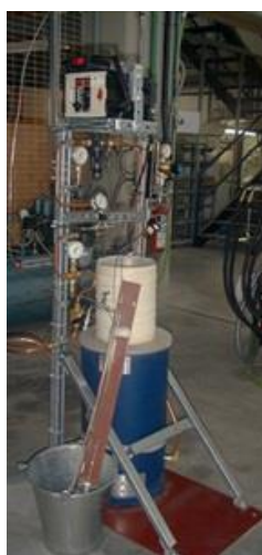
Εικόνα 3.10: Φωτογραφία διάταξης αντιδραστήρα μεταπολυμερισμού στερεάς κατάστασης στο Ημιβιομηχανικό Εργαστήριο της Σχολής Χημικών Μηχανικών (Ε.Μ.Π.).
