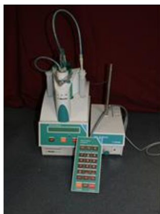
Εικόνα 3.16: Ο αυτόματος τιτλοδότης, 716 DMS Titrino της εταιρείας Brinkman Instruments, που χρησιμοποιήθηκε για τον προσδιορισμό της συγκέντρωσης των ομάδων, -\text{COOH} .
