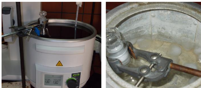
Εικόνα 3.15: Θέρμανση και απότομη ψύξη του τήγματος του PBS (quenching).
