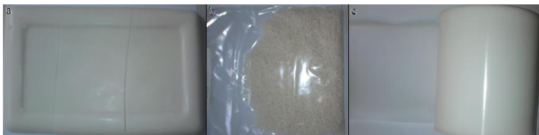
Εικόνα 3.1: PBS 13100 a) σε μορφή μεγάλων ορθογώνιων πλακών, b) σε κοκκώδεις μορφή και c) PBS Foils , σε μορφή λεπτών φύλλων.
