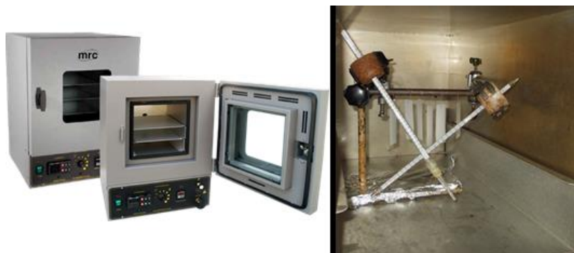
Πίνακας 3.12: Φούρνος mrc oven 1425/1445/1465, αριστερά και εσωτερικό του φούρνου με κατάλληλη διάταξη στήριξης δειγμάτων και θερμομέτρα ελέγχου θερμοκρασίας αντίδρασης, δεξιά.
