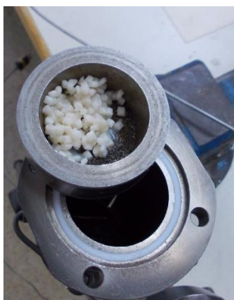
Εικόνα 3.9: Αντιδραστήρας στερεάς κλίνης, πορώδες μεταλλικό φίλτρο και κοκκοποιημένο δείγμα στο εσωτερικό του.
