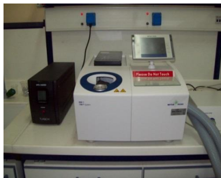
Εικόνα 3.19: Το σύστημα Mettler DSC 1STARe System που χρησιμοποιήθηκε για τις θερμικές αναλύσεις.
