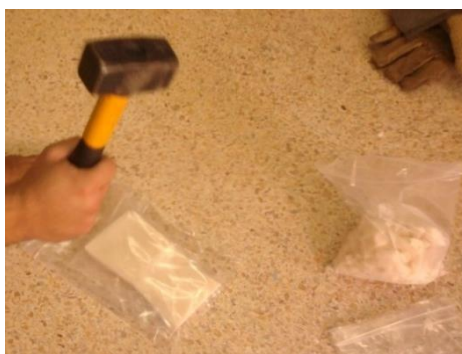
Εικόνα 3.8: Άσκηση φορτίου σε εμβαπτισμένο δείγμα PBS σε υγρό άζωτο, αριστερά και δείγματα μικρού μεγέθους δειγμάτων PBS ύστερα από την άσκηση φορτίου, δεξιά.
