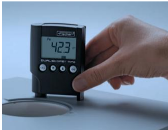
Εικόνα 21. Παχύμετρο Dualscope® MPO για την μέτρηση επίστρωσης σε σίδηρο (Fischer 2014).
