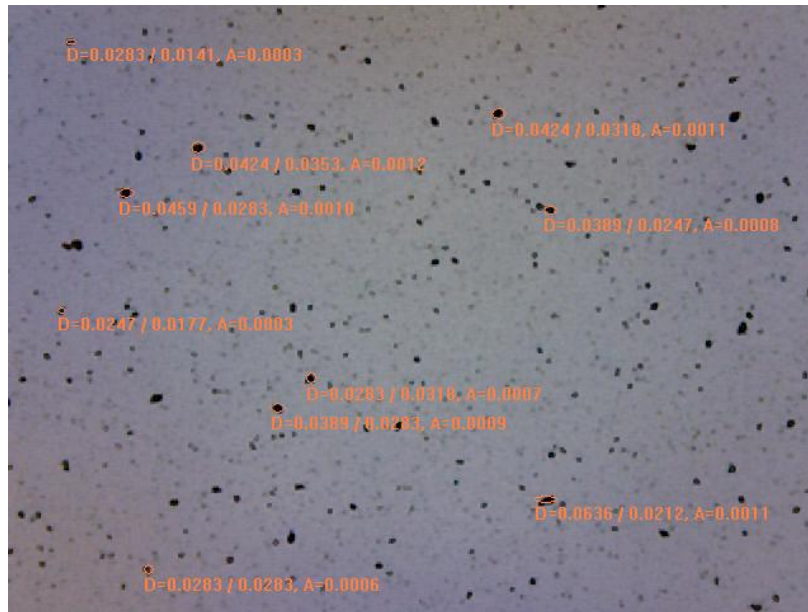
Εικόνα 37. Εικόνα ψηφιακού μικροσκοπίου (500x) της επίστρωσης PDMS/2152 0.1%
