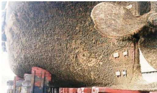
Εικόνα 1. Πρόβλημα βιορύπανσης στα ύφαλα ενός εμπορικού πλοίου (T&C Marine 2012).
