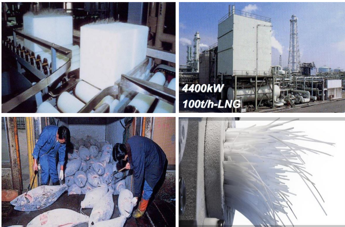
Σχήμα 3.6: Φωτογραφίες από τις κύριες διαδικασίες αξιοποίησης του κρύου από το ΥΦΑ στο σταθμό Negishi στην Ιαπωνία (πηγή: LNG world news και [27])
