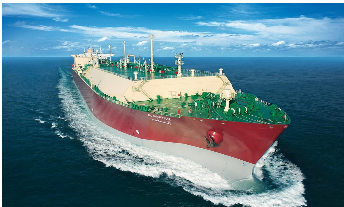
Σχήμα 1.6 : Al Mafyar, το μεγαλύτερο δεξαμενόπλοιο ΥΦΑ τύπου Q-MAX τύπου μεμβράνης με χωρητικότητα 266 000 κυβ. μέτρα, μήκος 345 μ. ,πλάτος 54 μ. ( www.lngworldnews.com )
