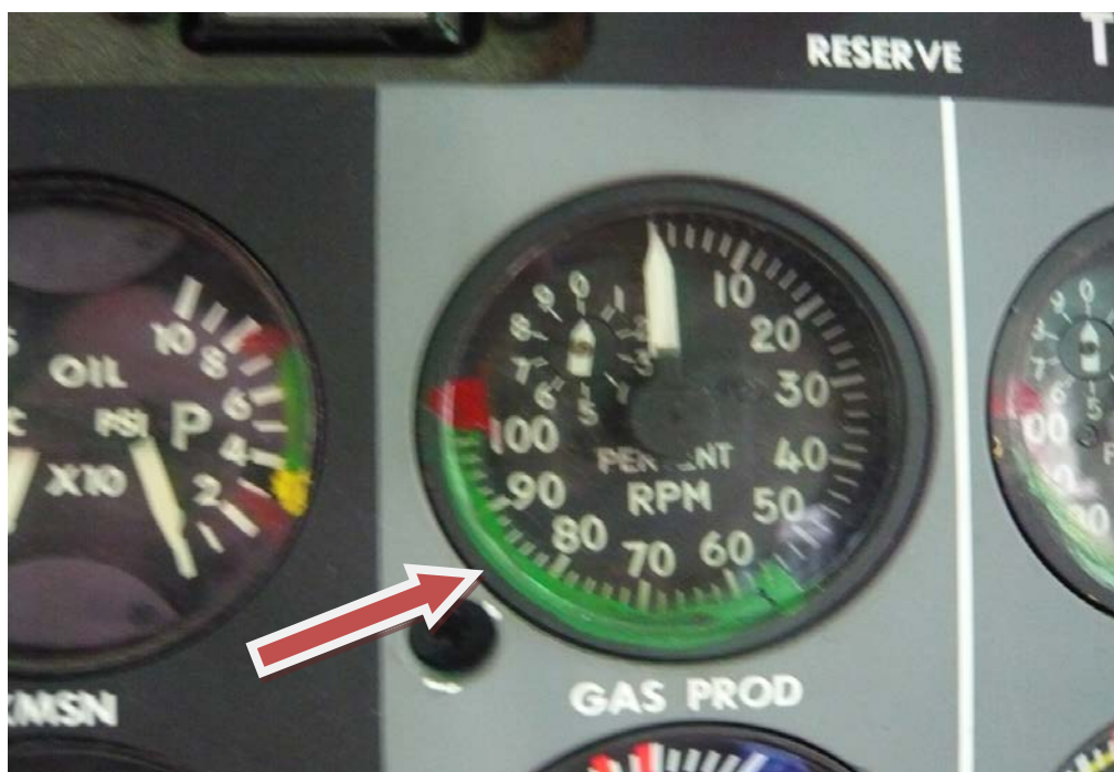
Σχήμα 4.4: Όργανο ένδειξης στροφών τουρμπίνας συμπίεσης (Ng)
