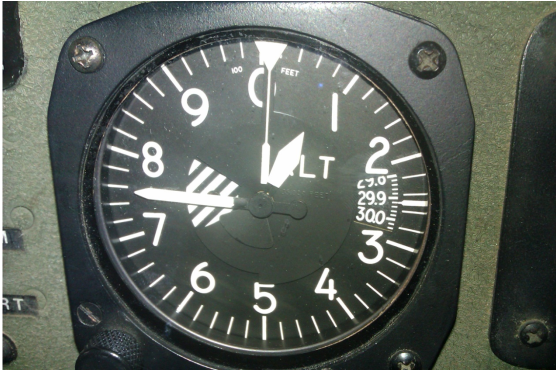
Σχήμα 4.44: Όργανο υψομέτρου με βαρομετρική πίεση
