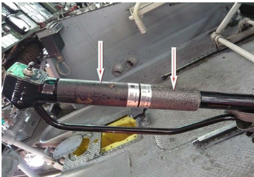
Σχήμα 4.2: Μανέτες No1 και No2 επί χειριστηρίου ανόδου-καθόδου
