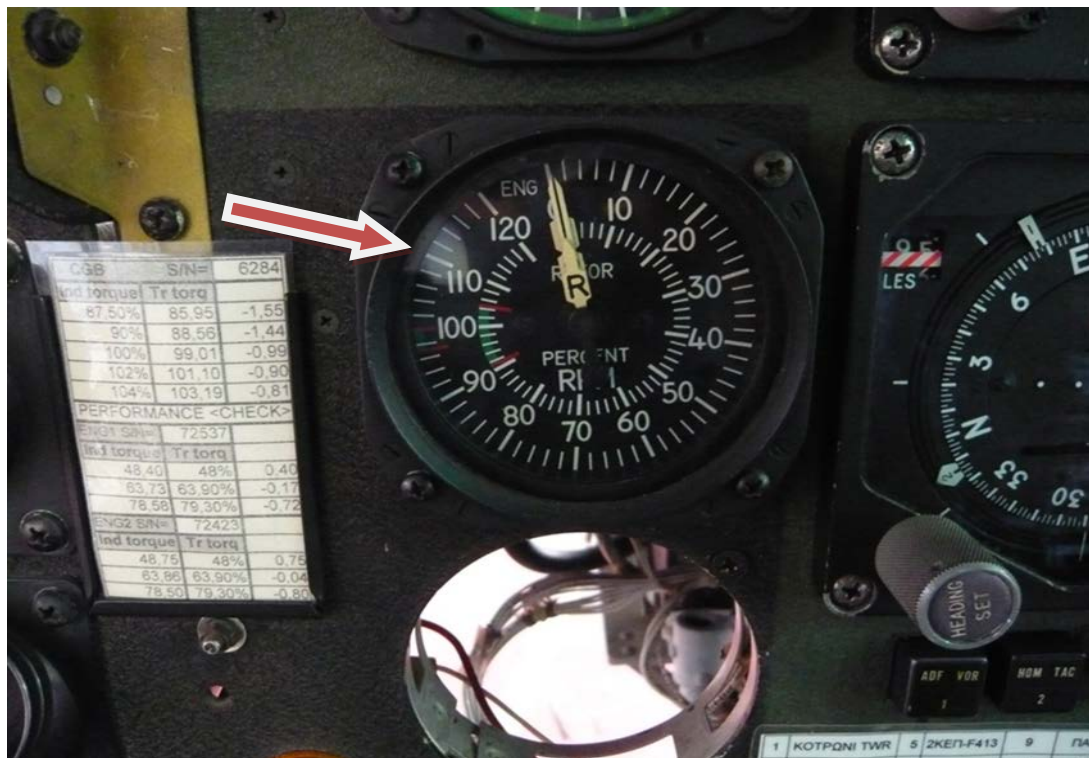
Σχήμα 4.19: Όργανο ένδειξης στροφών τουρμπίνας ισχύος και κυρίου στροφεύου
