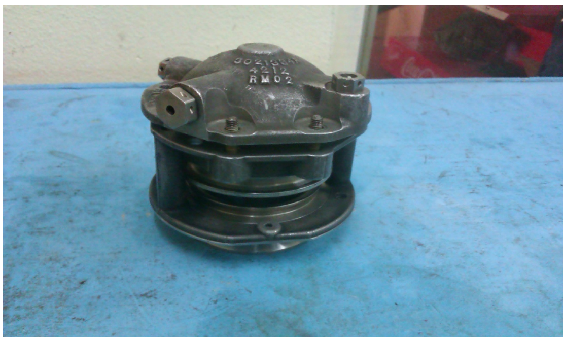
Σχήμα 4.28: Ανακουφιστική βαλβίδα του συμπιεστή
