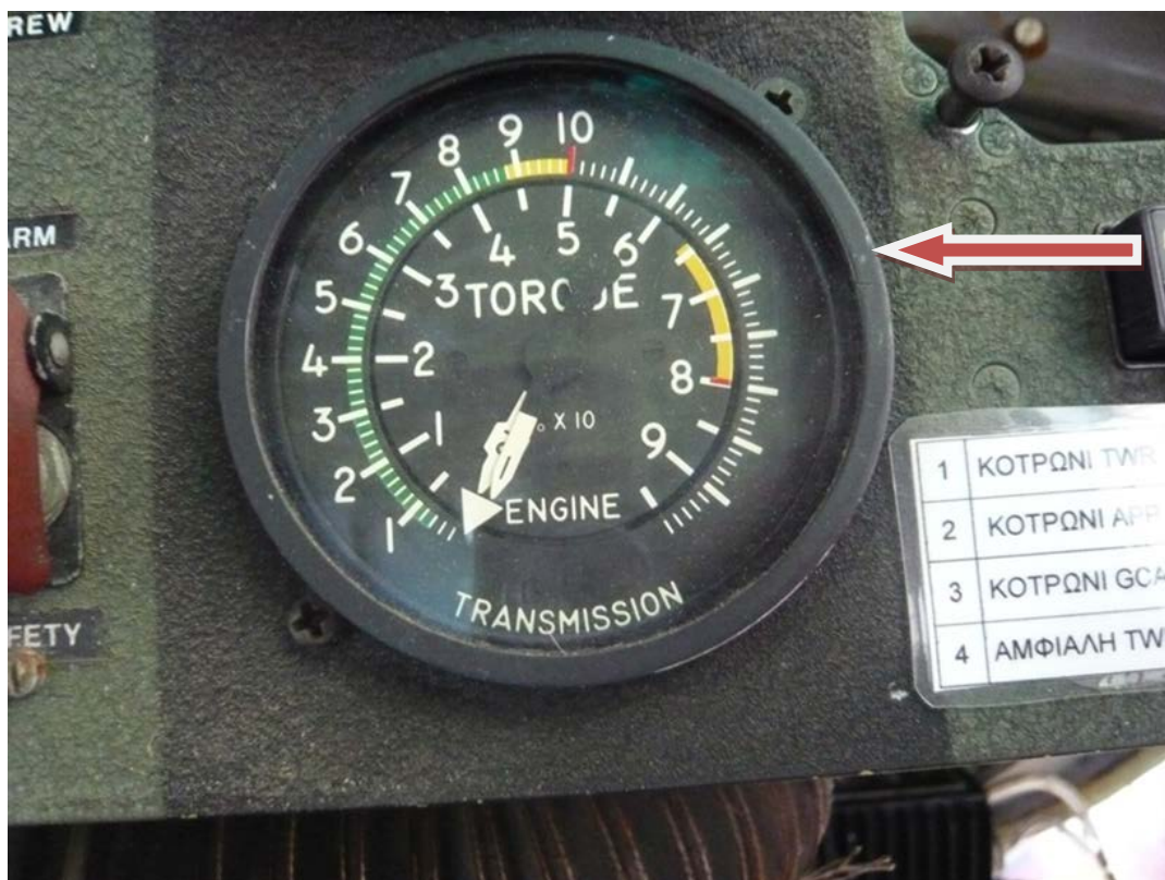
Σχήμα 4.17: Όργανο ένδειξης ροπής στρέψης κινητήρων και κεντρικού γραναζοκιβωτίου
