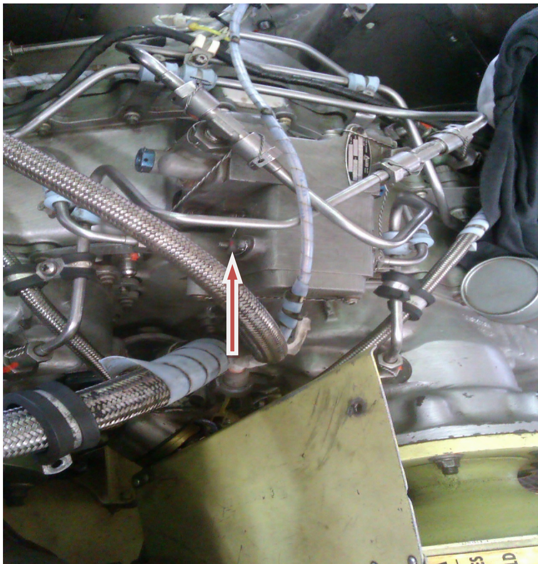
Σχήμα 4.54: Ρυθμιζόμενος περιοριστής ροπής στρέψης μονάδας ελέγχου ροπής στρέψης κινητήρων
