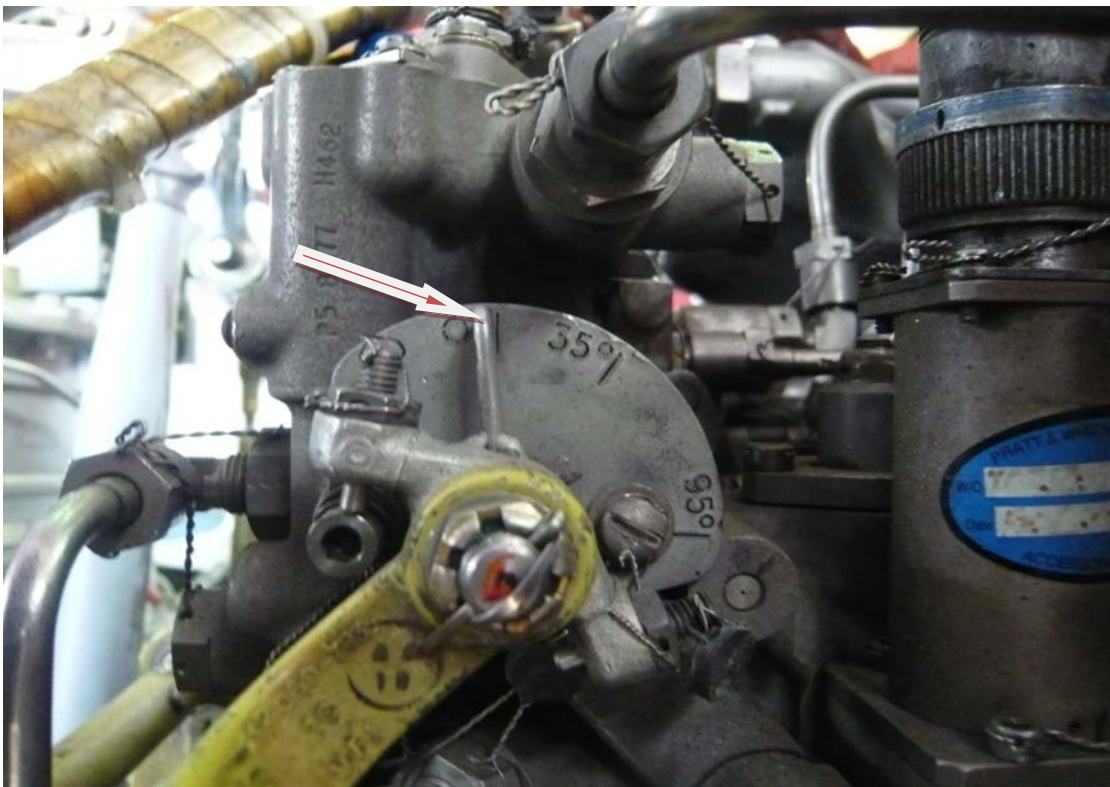
Σχήμα 4.41: Ακίδα ένδειξης θέσης μανετών
