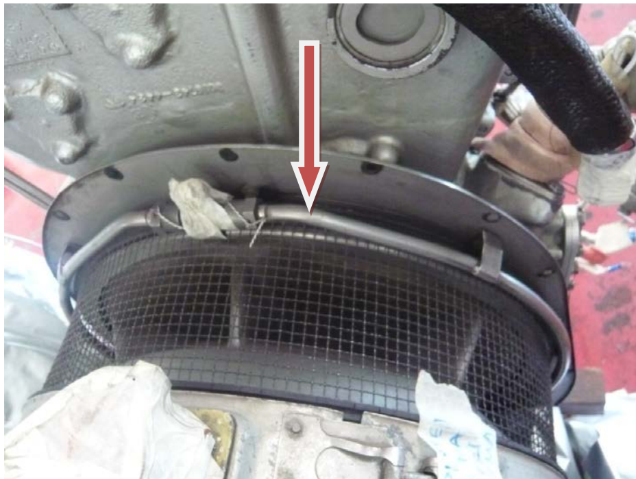
Σχήμα 4.8: Δαχτυλίδι 50 οπών ψεκασμού
