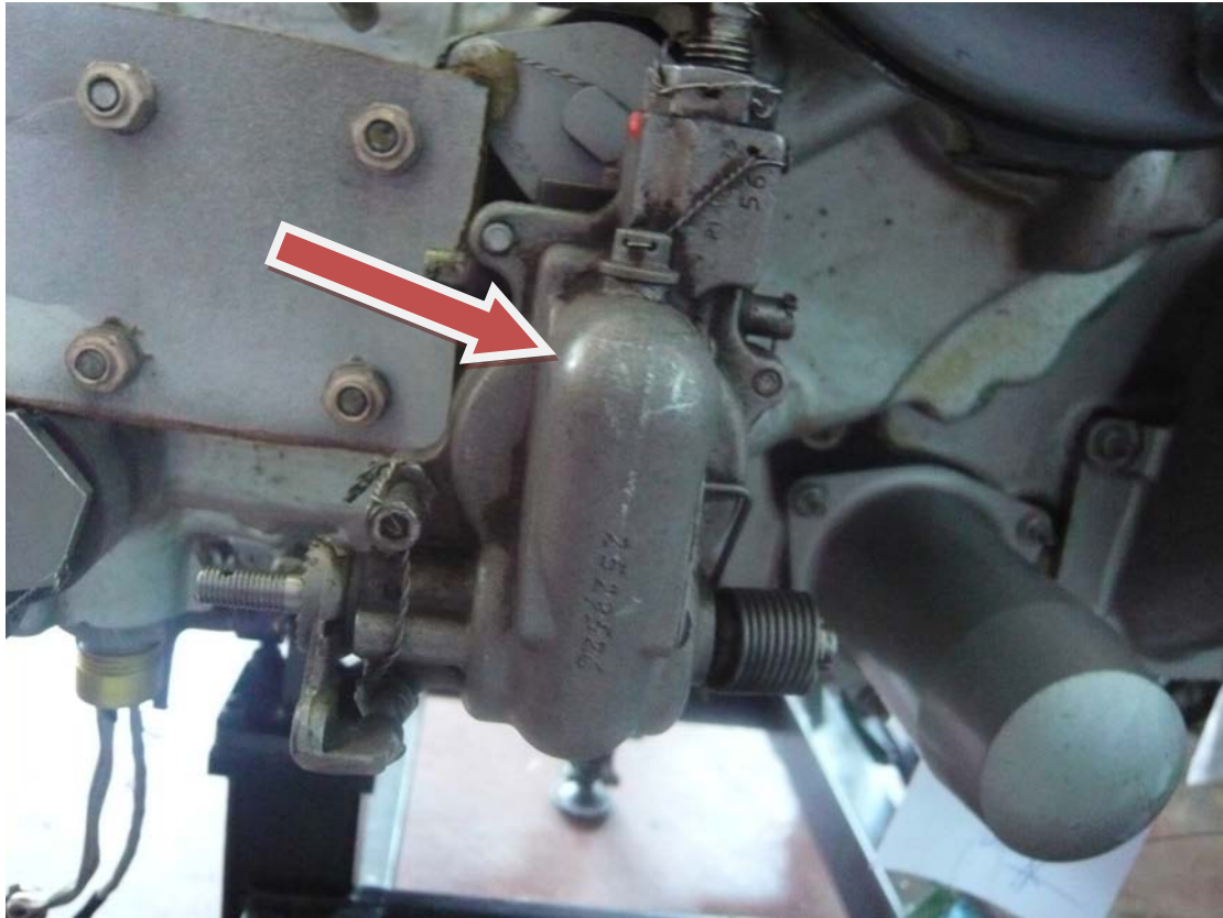
Σχήμα 4.20: Ρυθμιστής στροφών τουρμπίνας ισχύος
