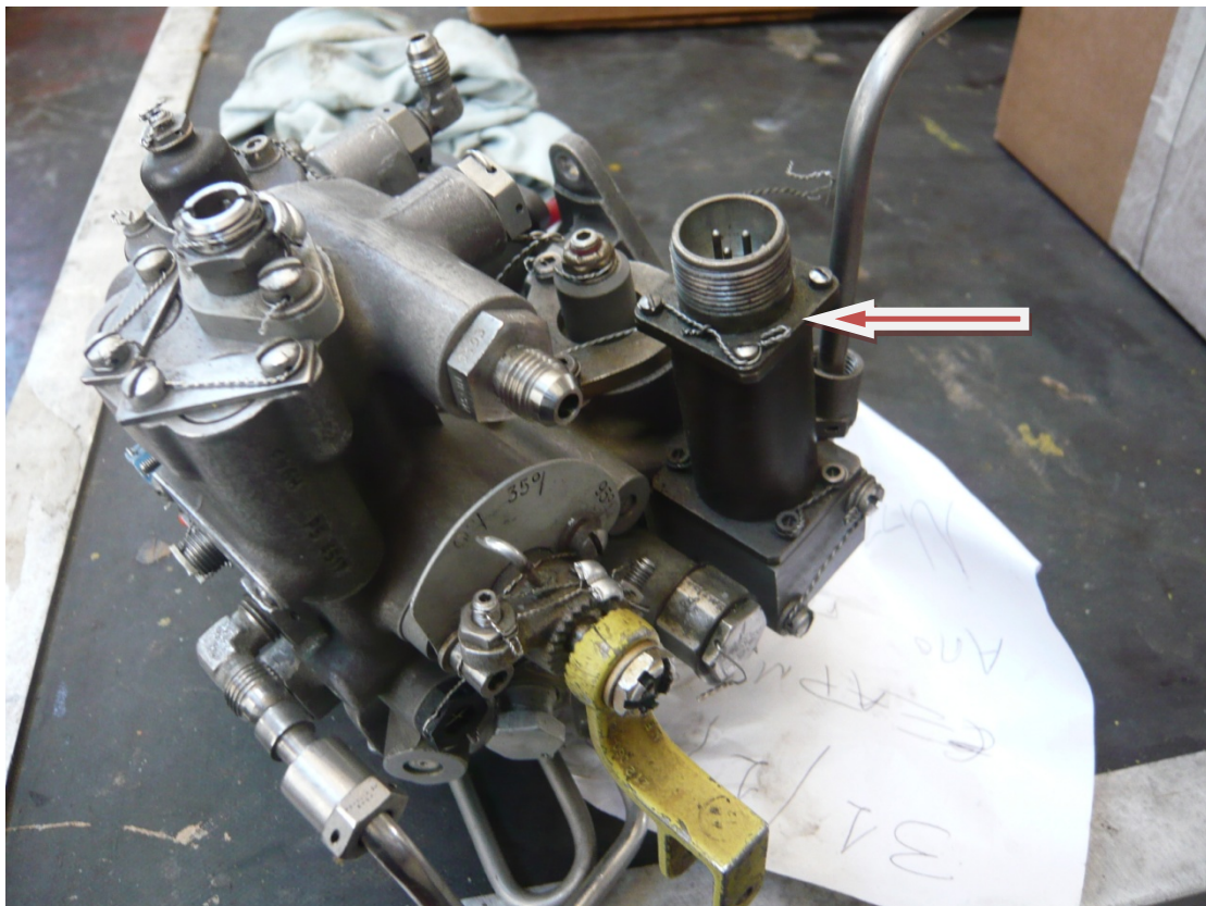
Σχήμα 4.11: Ηλεκτρική βαλβίδα μονάδας χειροκίνητου ελέγχου καυσίμου
