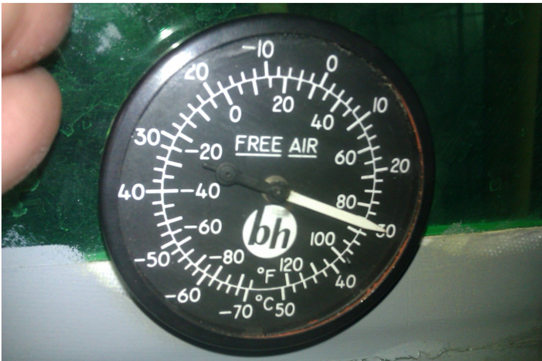
Σχήμα 4.34: Όργανο ένδειξης εξωτερικής θερμοκρασίας
