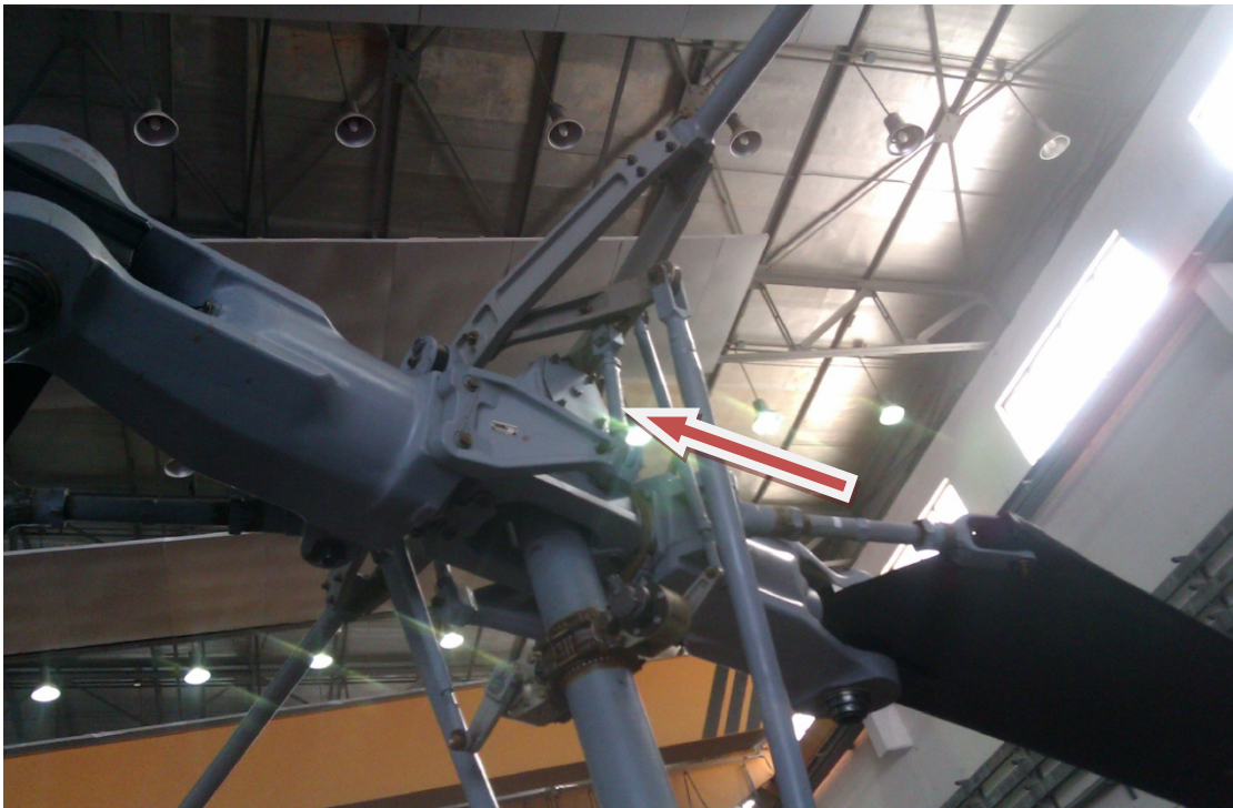
Σχήμα 4.48: Ράβδος αλλαγής βήματος
