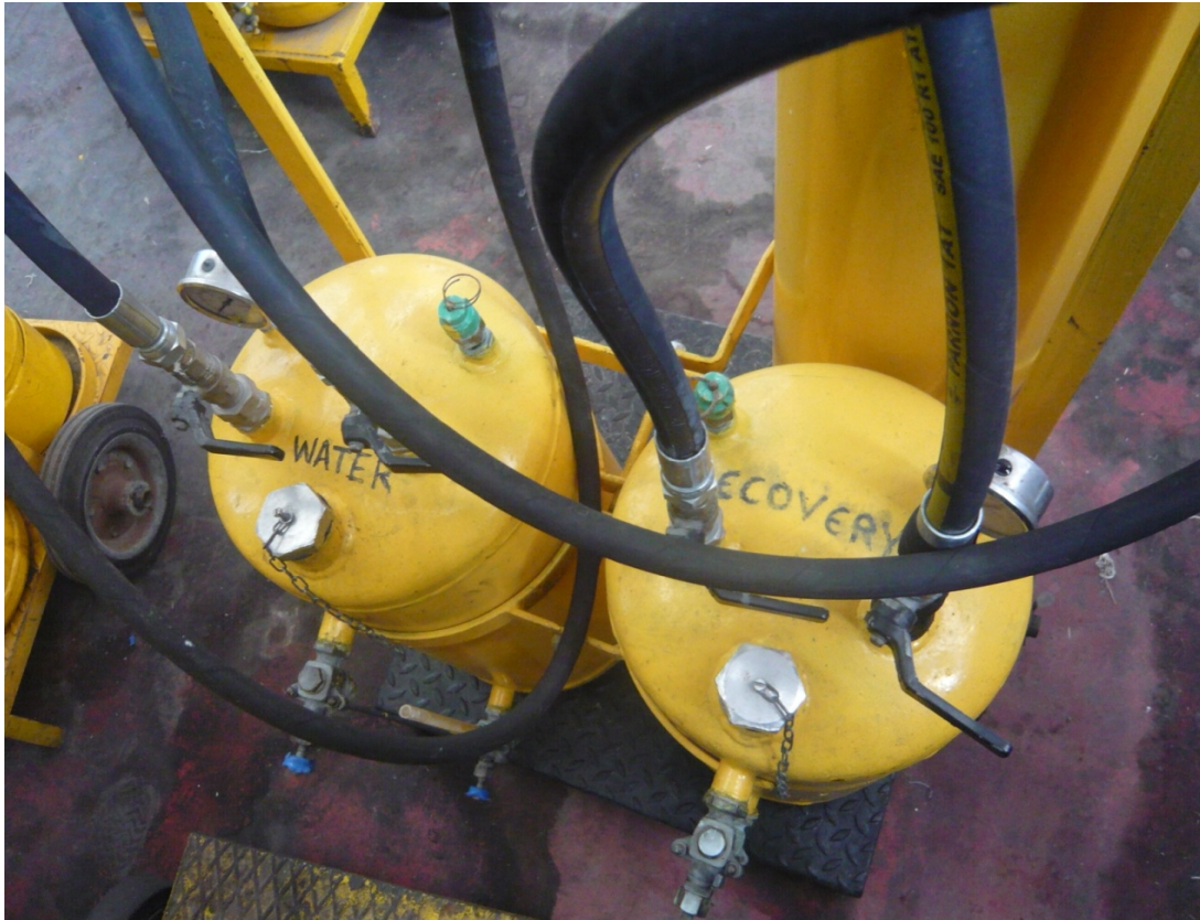
Σχήμα 4.5: Συσσκευή πλύσεως κινητήρα
