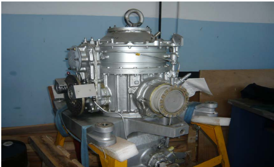
Σχήμα 4.53: Κεντρικό γρاناζοκιβώτιο μετάδοσης κίνησης
