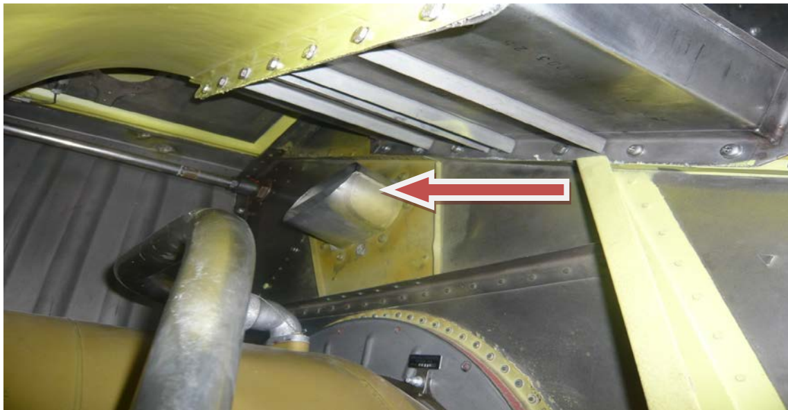
Σχήμα 4.27: Κατάθλιψη ανακουφιστικής βαλβίδας
