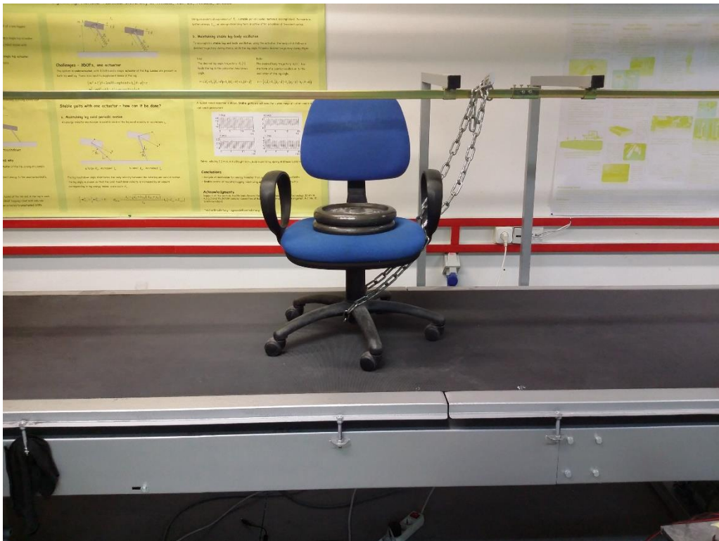
Σχήμα 6-10. Πείραμα μεταβολής φορτίου πάνω στον ιμάντα.
