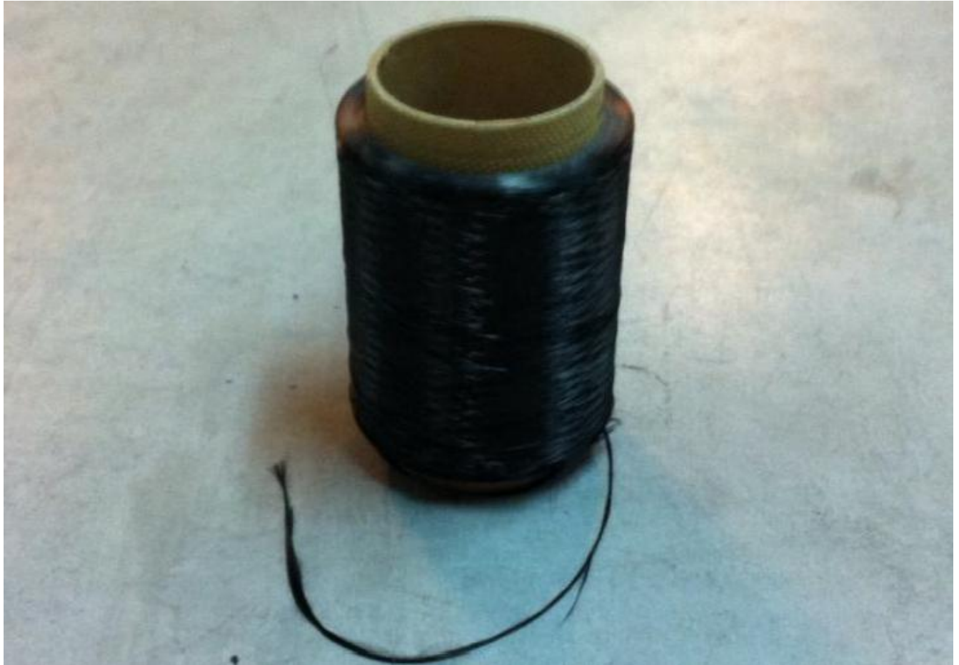
Εικόνα 9. Τύμπανο ινών άνθρακα
