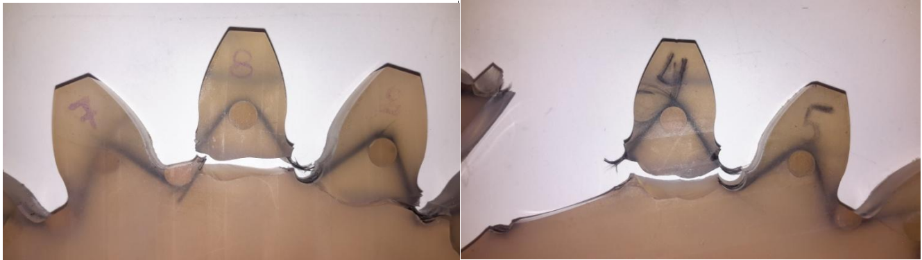
Εικόνα 87. Θραύση για τους οδόντες Νο 8 και Νο 4 με πλήρη κατάρρευση της μήτρας και της ενίσχυσης
