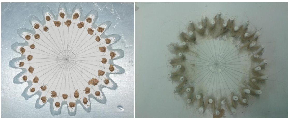
Εικόνα 67. Κατασκευή νέου καλουπιού α)καλούπι από dow (αριστερά) και β) ενίσχυση (δεξιά)
