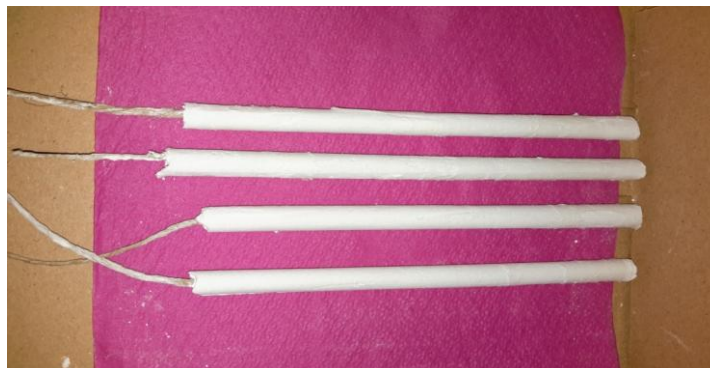
Εικόνα 66. Κατασκευή ενισχυμένων πείρων με λινή ενίσχυση στο κέντρο
