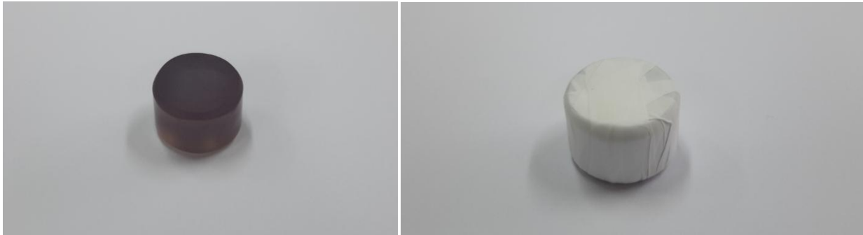
Εικόνα 71. Δοκίμιο θλίψης α)χωρίς τεφλόν και β)με τεφλόν
