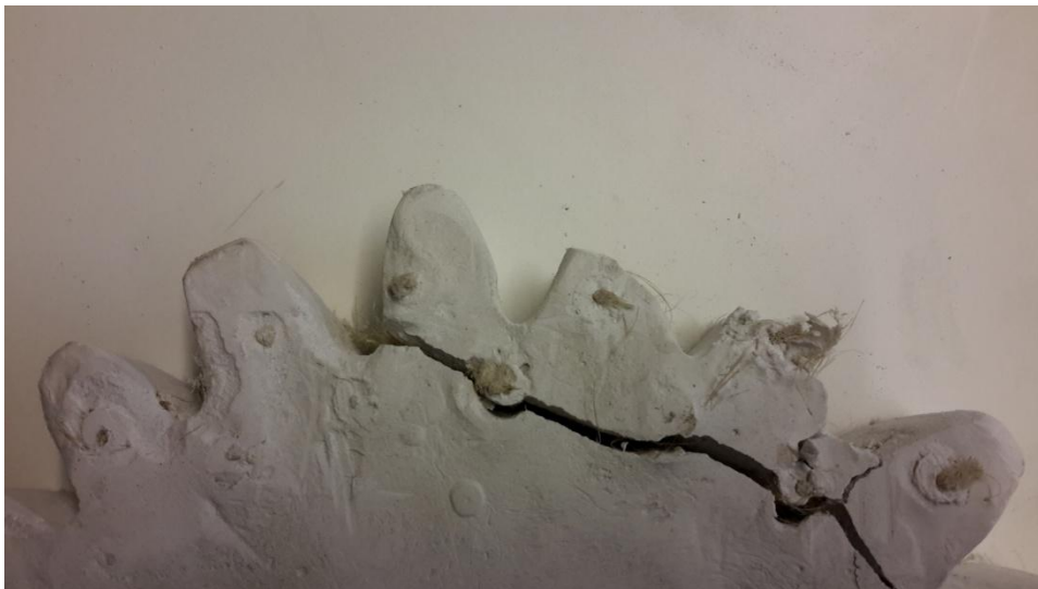
Εικόνα 69. Παρουσίαση θραύσης γύψινου μοντέλου με τη νέα ενίσχυση
