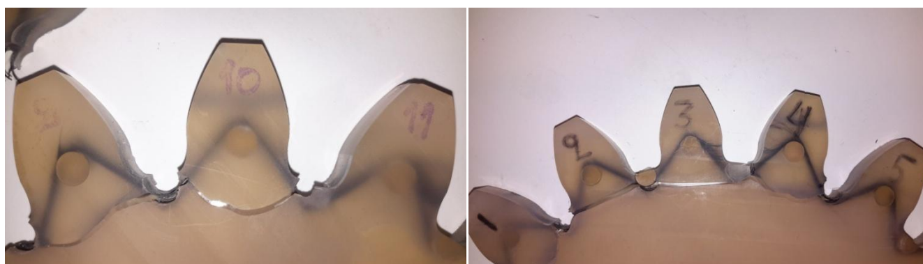
Εικόνα 86. Θραύση για τους οδόντες Νο10 και Νο3 με κατάρρευση μόνο της μήτρας
