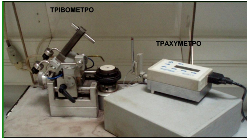
Εικόνα 7. Τυπικό Τριβόμετρο και τραχύμετρο για τις ανάγκες του πειράματος
