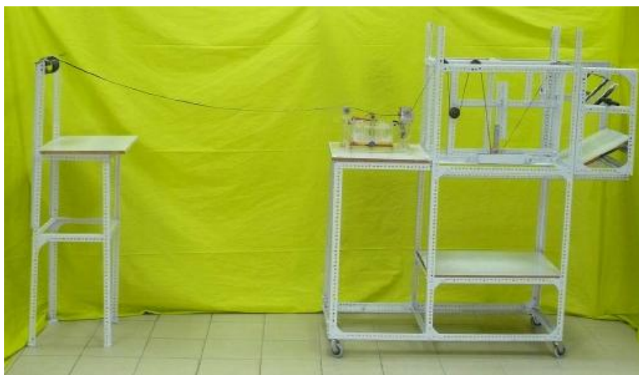
Εικόνα 3. Διάταξη προδιαπότισης ινών άνθρακα στο εργαστήριο
