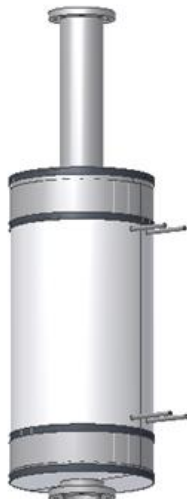
(ε) Στήριξη της αντίστασης στο αντιδραστήρα
