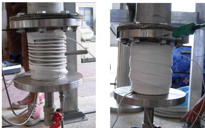
Εικόνα 2.37. Τοποθέτηση αντιστάσεων στον διασκορπιστή
