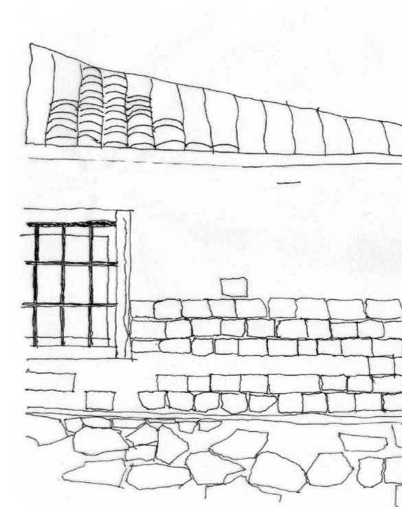
ΜΕΙΚΤΟΣ ΤΡΟΠΟΣ ΚΑΤΑΣΚΕΥΗΣ: Η ΒΑΣΗ ΤΟΥ ΣΠΙΤΙΟΥ ΓΙΝΟΤΑΝ ΑΠΟ ΠΕΤΡΑ ΚΑΙ ΤΟ ΥΠΟΛΟΙΠΟ ΑΠΟ ΧΩΜΑΤΟΠΛΙΝΘΑ
