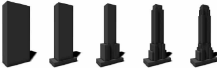
Εικόνα 62 : Πέντε διαδοχικά στάδια παραγωγής ενός κτιρίου στο CityEngine. Το L- Σύστημα επιτρέπει την οριοθέτηση των κτιρίων, δίνοντας έτσι τη δυνατότητα παραγωγής διαφορετικών επιπέδων λεπτομέρειας- LOD (πηγή : Parish και Müller, 2001)
