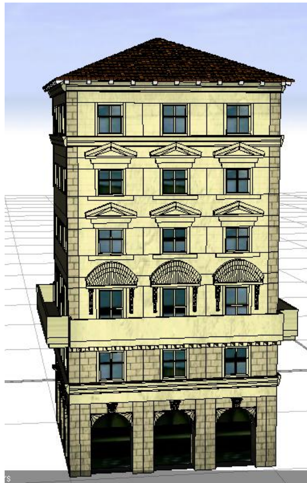
Εικόνα 79 : 3D μοντέλο κτιρίου στο CityEngine, στο οποίο εφαρμόστηκε κανόνας CGA σε όλες τις όψεις
