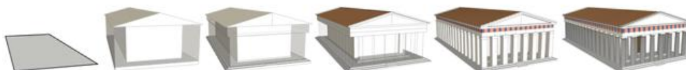
Εικόνα 52 : Διαδικασία παραγωγής του τελικού 3D μοντέλου με χρήση CGA Grammar (πηγή : esri.com, 2014)
