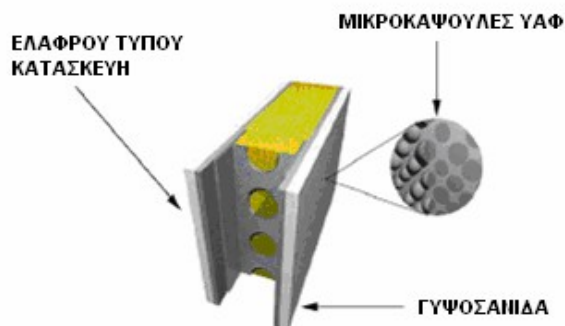
Εικόνα 5.9.12.3.4 : Σύγχρονη ελαφρού τύπου κατασκευή, εφοδιασμένη με γυψοσανίδες με ΥΑΦ
