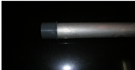
Εικόνα 5.9.1.1: Αλουμινίου σωλήνες με pcm
