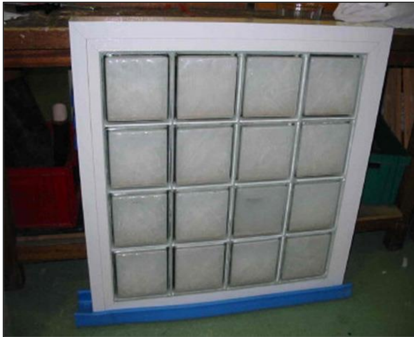
Σχήμα 3.12: Διαχωριστικό τοίχωμα με 16 υαλότουβλα γεμάτα με PCM
