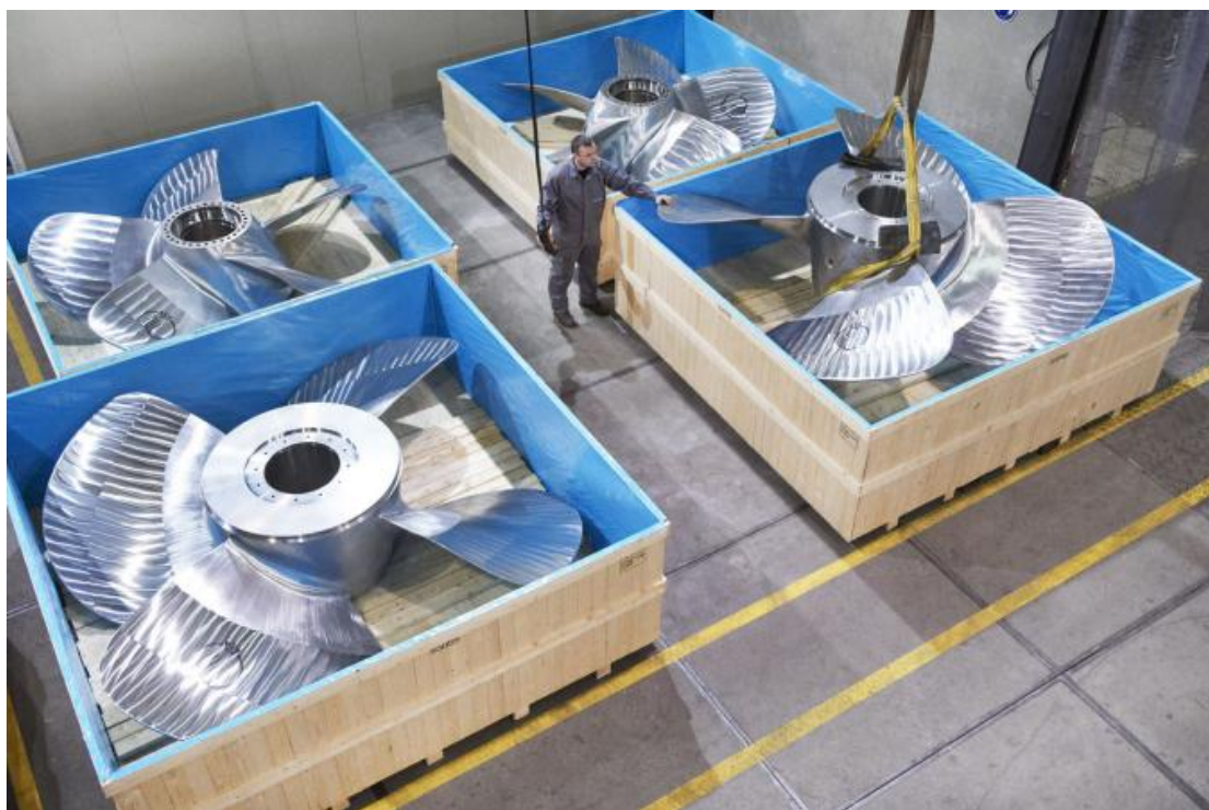
Εικόνα 4.13. Τέσσερις προπέλες από ωστενιτικό ανοξείδωτο χάλυβα διαμέτρου 2900 και 3500 mm, με ice class notation IAS (σχεδιασμένες να λειτουργούν σε πολύ παγωμένες περιοχές κατά τον Finnish-Swedish ice class).
