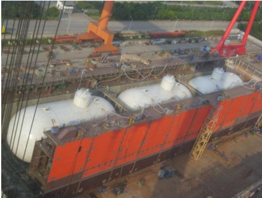
Εικόνα 4.5. Φωτογραφία από την κατασκευή ενός LNG με 3 δεξαμενές τύπου C συνολικής χωρητικότητας 16.100 m 3 .
