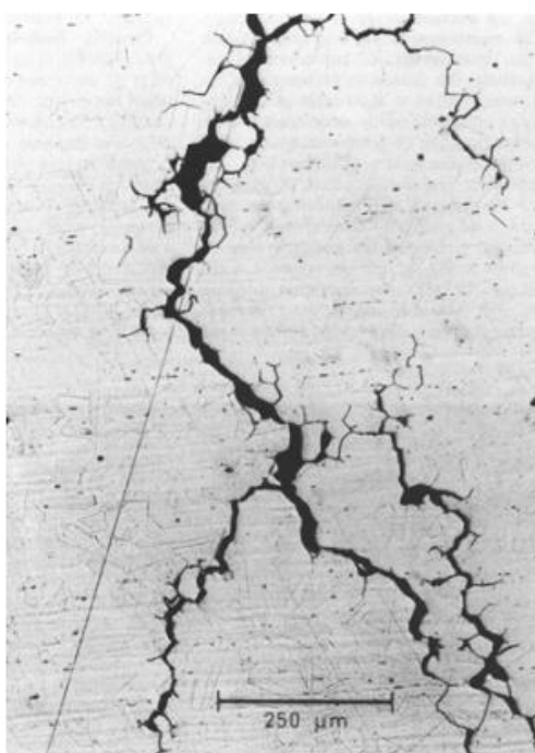
Εικόνα 3.8 Καυστική διάβρωση λόγω μηχανικής καταπόνησης στη ΘΕΖ ανοξειδωτου χάλυβα 316L. Οι ρωγμές είναι διακλαδιζόμενες και περικρυσταλλικές. [20]
