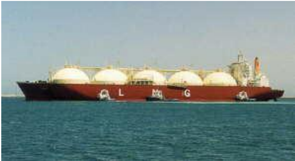
Εικόνα 4.1. Εικόνα από LNG vessel με δεξαμενές τύπου B (Kvaerner Moss system).
