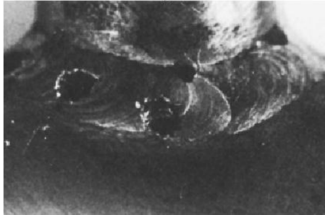
Εικόνα 3.3 Διάβρωση με βελονισμούς σε ένα λιγότερο κραματοποιημένο μέταλλο συγκόλλησης 308L (σε σχέση με το μέταλλο βάσης). Το μέταλλο βάσης, 316L δεν επηρεάστηκε. (2.5x)[20].
