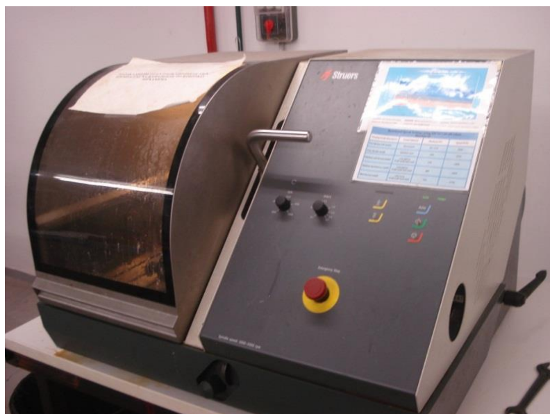
Εικόνα 5.3 Δισκοτόμος Struers Discotom 5.
