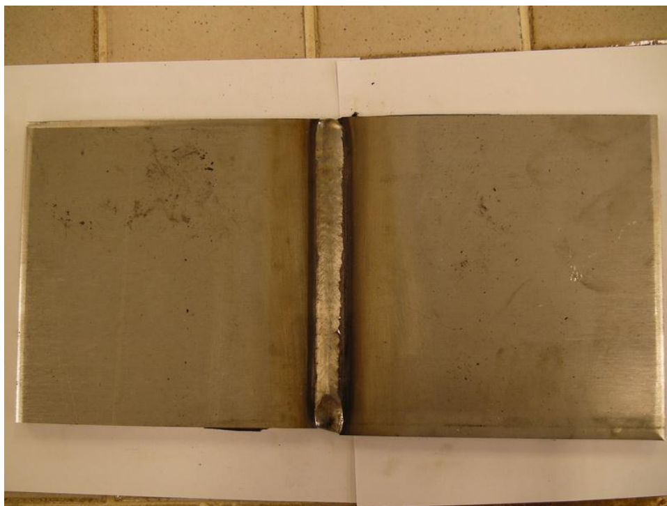
Εικόνα 5.1. Το συγκολλημένο έλασμα ανοξείδωτου χάλυβα 316L (300x300x12mm).
