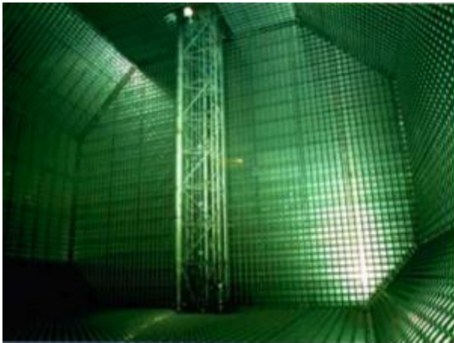
Εικόνα 4.9.Εικόνα από το εσωτερικό της δεξαμενής τύπου Membrane GTT Mark III.
