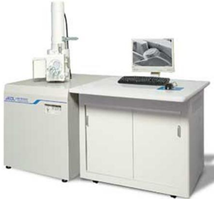
Εικόνα 5.10 Ηλεκτρονικό Μικροσκόπιο Σάρωσης τύπου JSM6390 της εταιρείας JEOL. Διακρίνονται η στήλη των ηλεκτρονίων, ο θάλαμος του δοκιμίου και η οθόνη του SEM.
