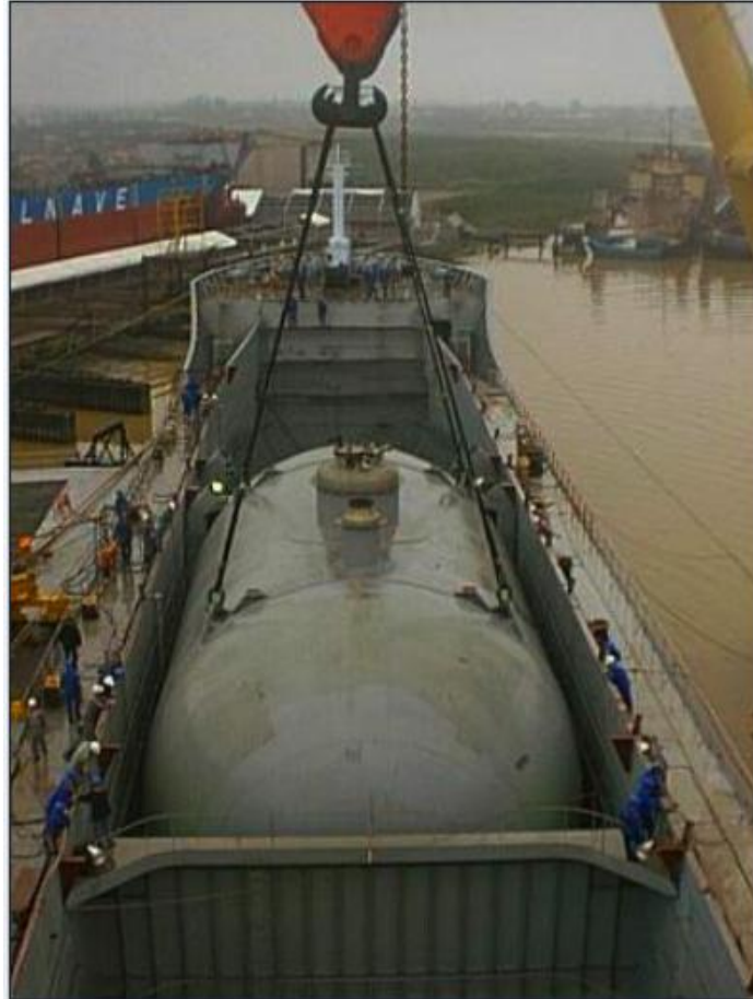
Εικόνα 4.4. Τοποθέτηση δεξαμενής τύπου C σε LNG/LPG κατασκευασμένη από ωστενιτικό ανοξείδωτο χάλυβα.
