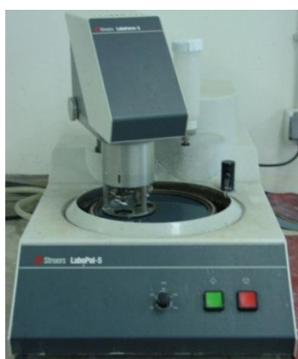
Εικόνα 5.4. Λειαντικό μηχάνημα Struers LaboPol 5.
