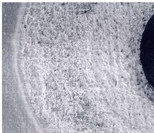
Εικόνα 2.2. Διάβρωση χαραγής σε φλάντζα από χάλυβα 316L (SEM X15).[69]
