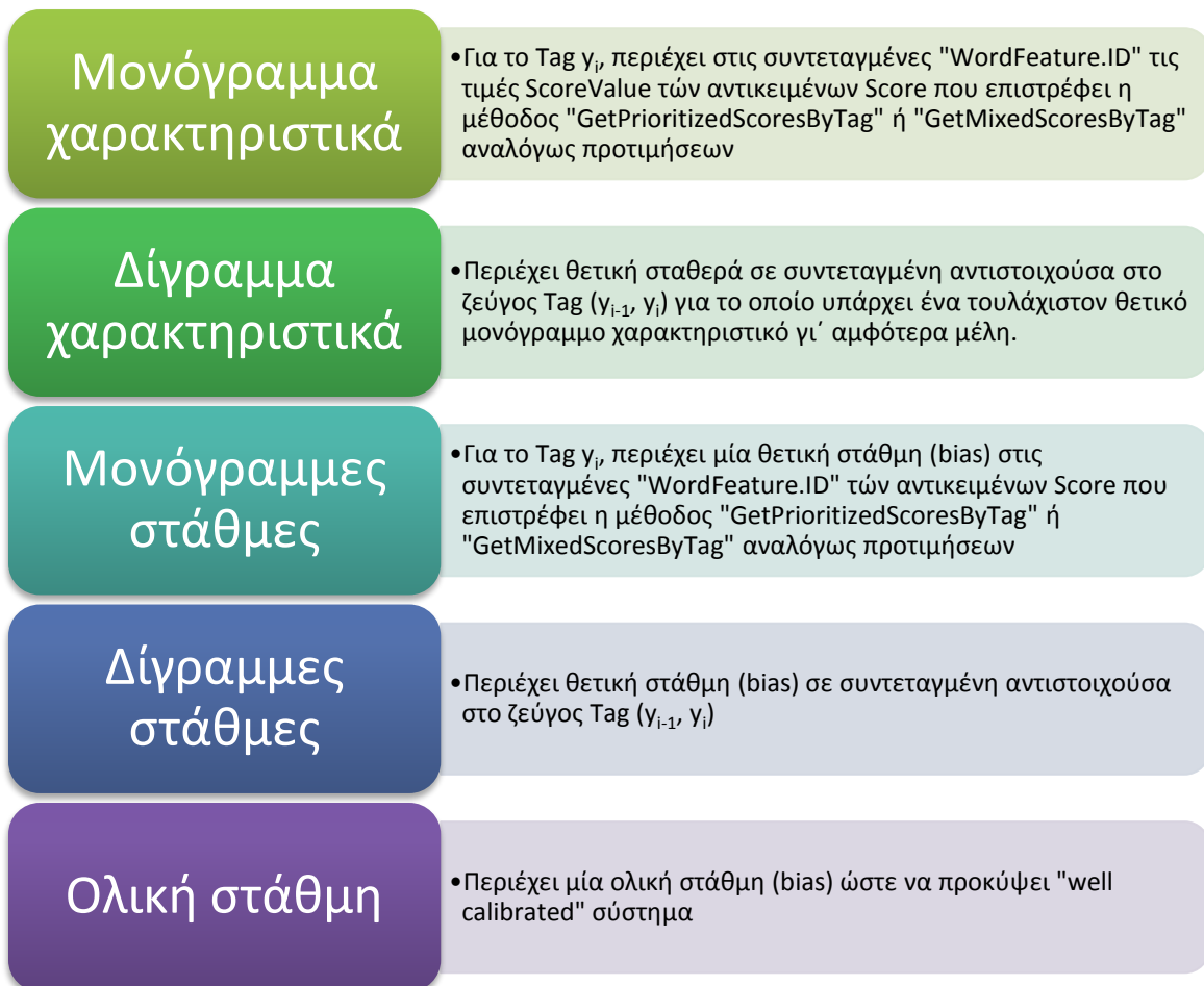
Σχήμα 3-22: Δομή τού διανύσματος που επιστρέφει η διανυσματική συνάρτηση χαρακτηριστικών f(x, y_{i-1}, y_i, i) όπως ορίζεται από την κλάση LanguageFeatureFunctionsProvider μέσω των αντικειμένων ScoreBank που περιέχει για κάθε συστατικό μίας προτάσεως
