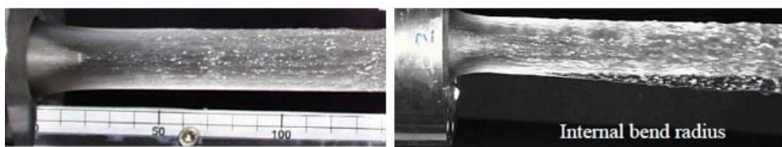
Σχήμα 1.24: Ελεύθερη δέσμη εξερχόμενη από ακροφύσιο συνδεδεμένο με ευθύ αγωγό (αριστερά) και γωνία 90^\circ (δεξιά) ανάντι [27]
