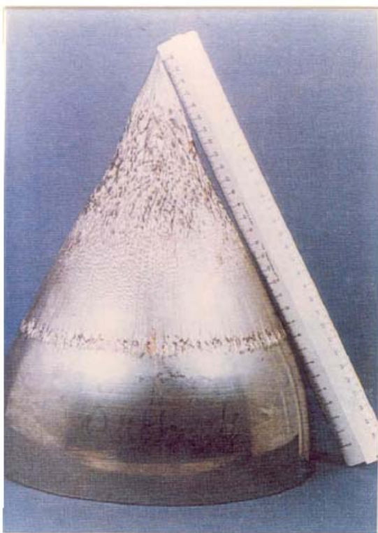
Σχήμα 1.48: Εκτεταμένες φθορές στην επιφάνεια της βελόνης υδροστροβίλου Pelton [63]
