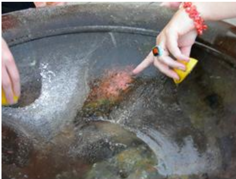
Εικόνα 6.1 Σημάδι τύπου firescale (CuO) πάνω σε Ag-Sterling
