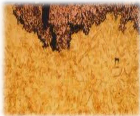
Εικόνα 2.6 Αποψευδαργύρωση του ορείχαλκου σε δείγμα σωλήνα ενναλάκτη
