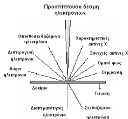
Εικόνα 8.12 Φαινόμενα αλληλεπίδρασης δέσμης - δείγματος
