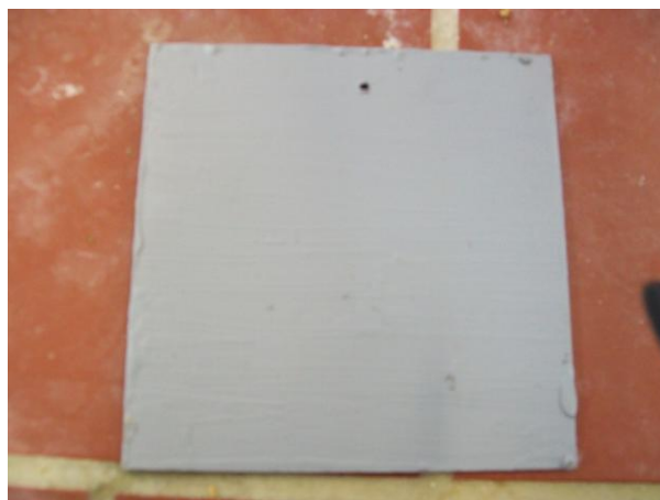
Εικόνα: Δοκίμιο με επίστρωμα αστάρι μετάλλων
