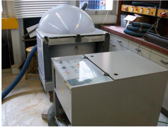
Εικόνα: Διάταξη θαλάμου Αλατονέφωσης
