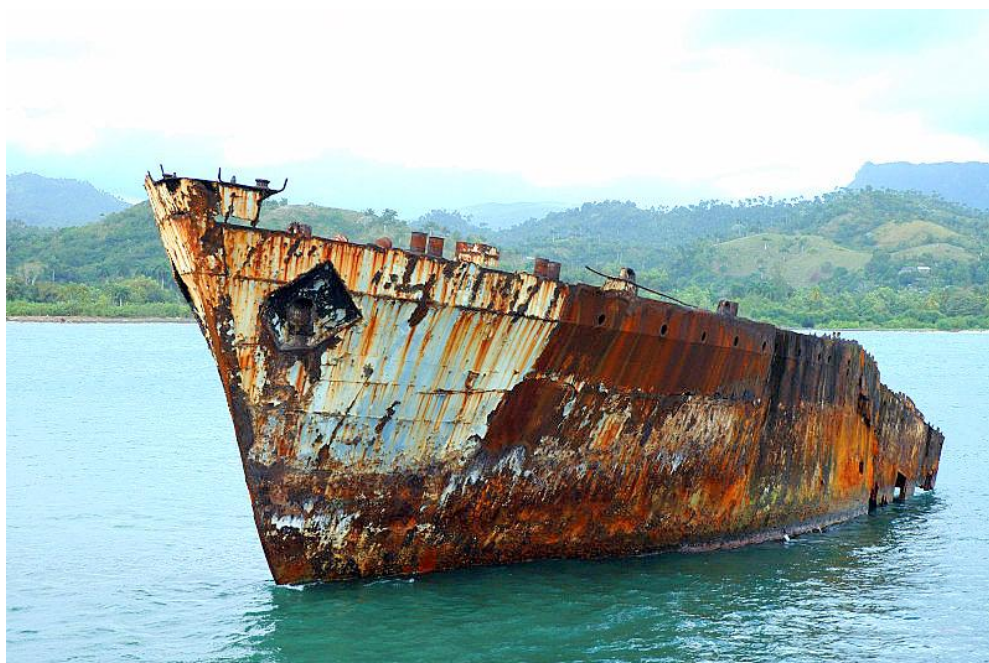
Εικόνα: Διάβρωση σε γάστρα πλοίου.
