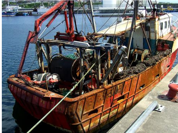
Εικόνα: Διάβρωση σε πλοίο
