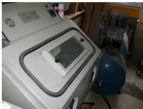
Εικόνα: Διάταξη Ψηγματοβολής
