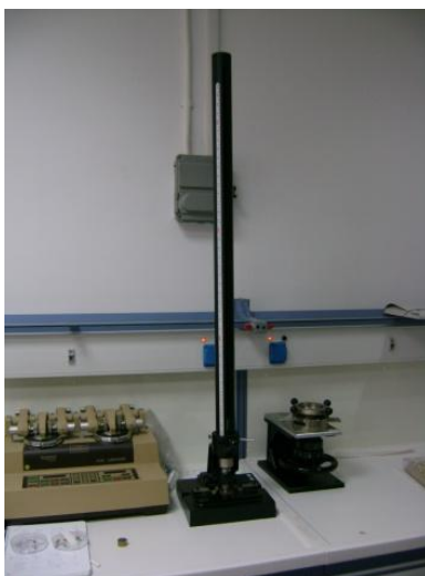
Εικόνα: Δοκιμή σε Κρούση – Πίπτον Βάρος.
