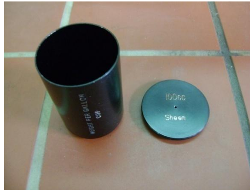
Εικόνα: Κυλινδρικό δοχείο για την μέτρηση της πυκνότητας.
