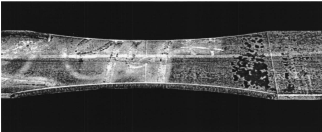
Σχήμα 2.10 - Απομειωμένο τμήμα διατομής δοκού
