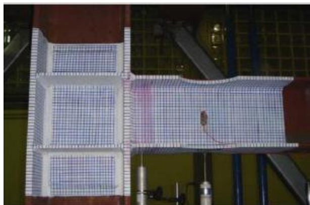
Σχήμα 2.18 - Σχεδιασμένος κάναβος στο στοιχείο
