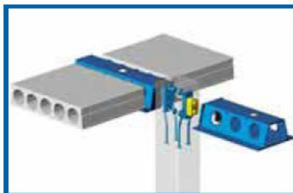
Σχήμα 2.4 - Σύνδεση δοκού delta σε υποστύλωμα
