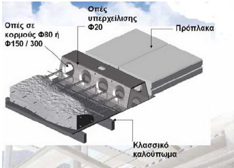
Σχήμα 2.2 - Σκυροδέτηση Deltabeam μέσω υποστήριξης
