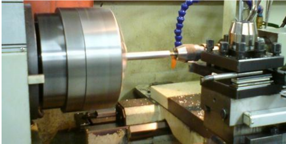
Σχ. 4.5: Φωτογραφία κατά την κατασκευή των δοκιμίων σε τόρνο.
