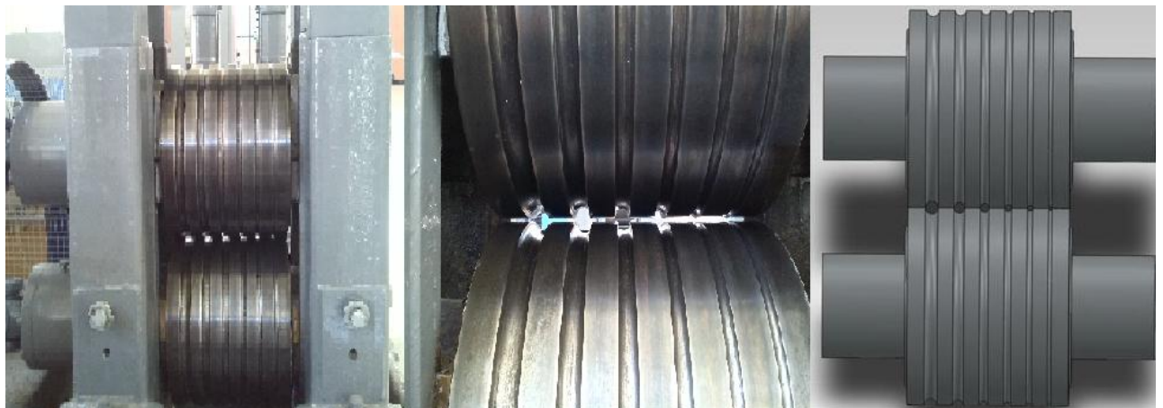
Σχ. 4.2: Φωτογραφία (αριστερά) και σχεδίαση (δεξιά) της διάταξης των τυμπάνων με κυλινδρικές αυλακώσεις. Στο κέντρο φαίνεται το διάκενο μεταξύ των τυμπάνων
