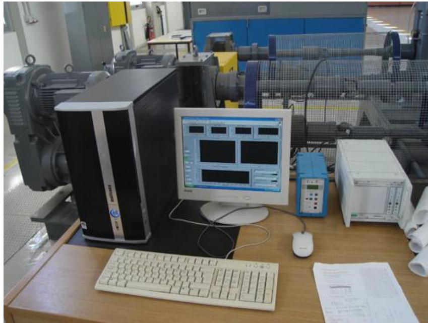
Σχ. 4.3: Φωτογραφία της μετρητικής διάταξης με τον ενισχυτή τού δυναμομέτρου (μπλε) και του ροπομέτρου (άσπρο) .
