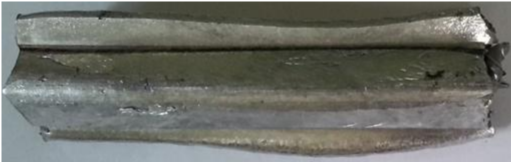
Σχ. 4.7: Φωτογραφία δοκίμιου μετά το πέρασμα ανάμεσα στα ράουλα, με τις προεξοχές που δημιουργούνται και πρέπει να αφαιρεθούν.
