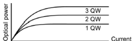
Εικόνα 3.7 Οπτική ισχύς εξόδου δομών μοναδικού (α) και πολλαπλών κβαντικών πηγαδιών (β)
