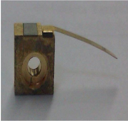
Εικόνα 4.2 Ο C-mount carrier (a) και η mounting base (b) που χρησιμοποιήθηκαν
