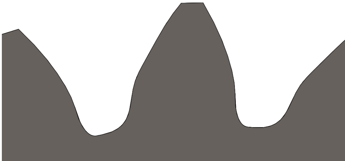
Σχήμα 6.19: Εστίαση στον οδόντα βελτιστοποιημένης καμπύλης με πάχος κεφαλής 0.4 φορές το module της οδόντωσης.
