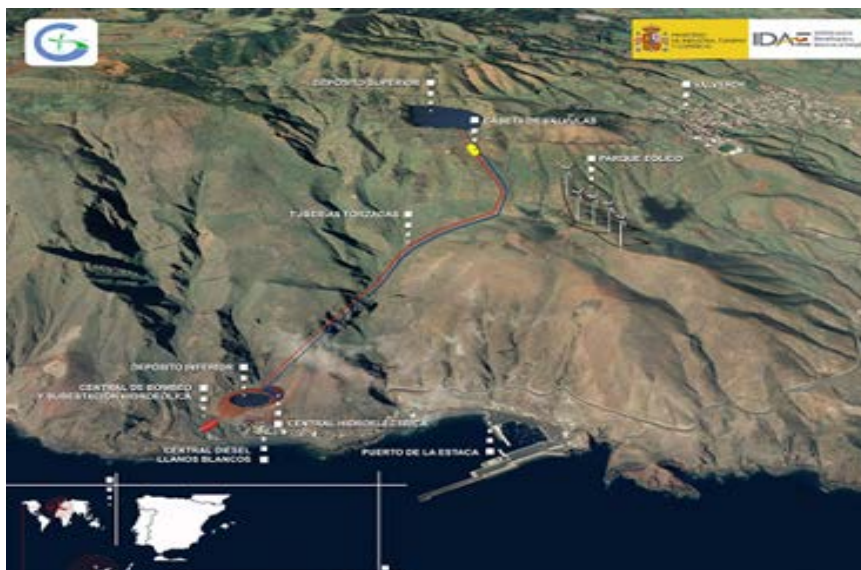
Εικόνα 16 Σχηματική απεικόνιση μονάδας αντλησιοταμίευσης στο El Hierro στα Κανάρια νησιά
