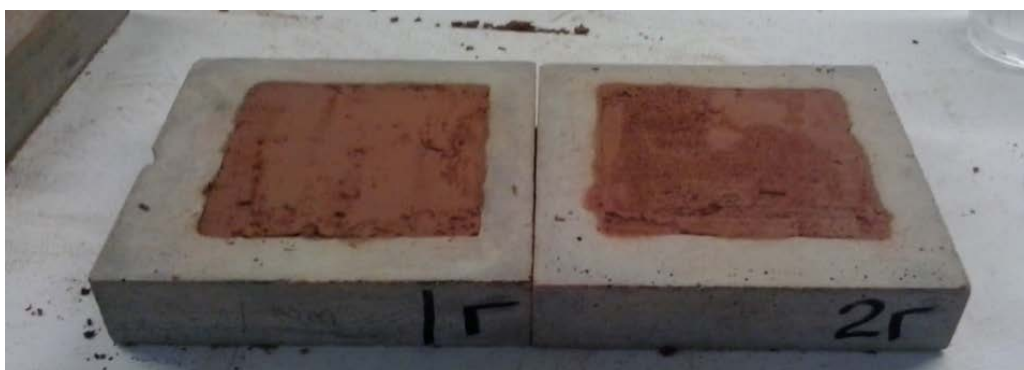
Εικόνα 26 - Βάση ρίψης με διαμορφωμένη επιφάνεια πρόσπτωσης
