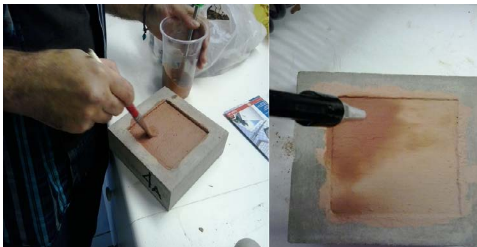
Εικόνα 27 - Στρώση με πινέλο υδαρούς αργιλικού υλικού και μετατροπή του σε ξηρό με πιστόλι αέρα
