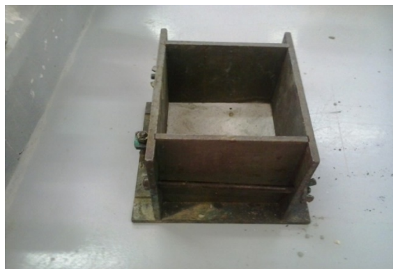
Εικόνα 22 - Μεταλλικό καλούπι για την διαμόρφωση των βάσεων
