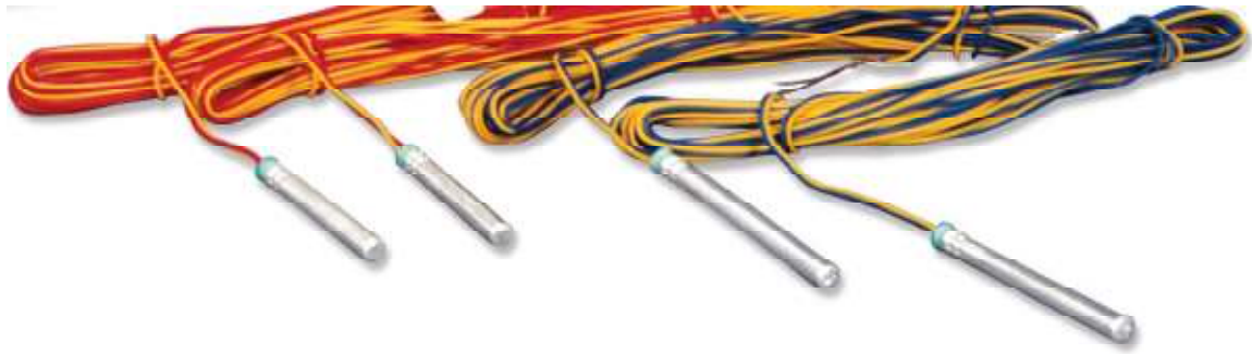
Εικόνα 6.5. Ηλεκτρικά καψύλλια επιβραδύνσεως. Διακρίνονται με κόκκινο χρώμα ηλεκτρικού αγωγού τα LP και με μπλε χρώμα τα MS.
