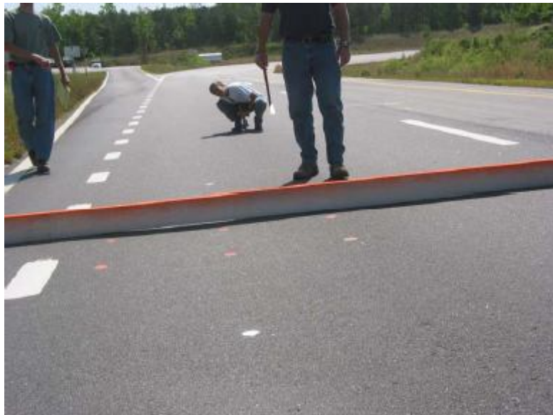
Εικόνα 2.5 : Χειρωνακτική μέτρηση αυλακώσεως (Πηγή : Wang, 2005)
