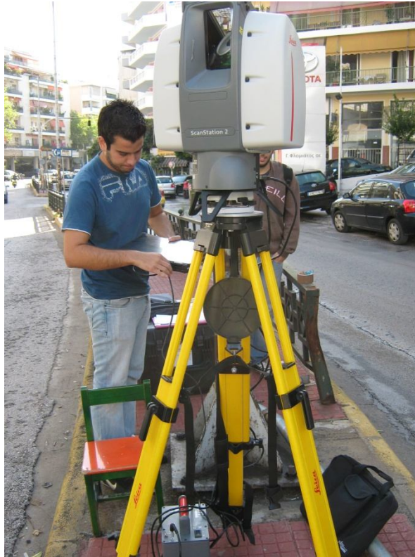
Εικόνα 3.11 : Σύνδεση σαρωτή με ηλεκτρονικό υπολογιστή για μέτρηση στο πεδίο
