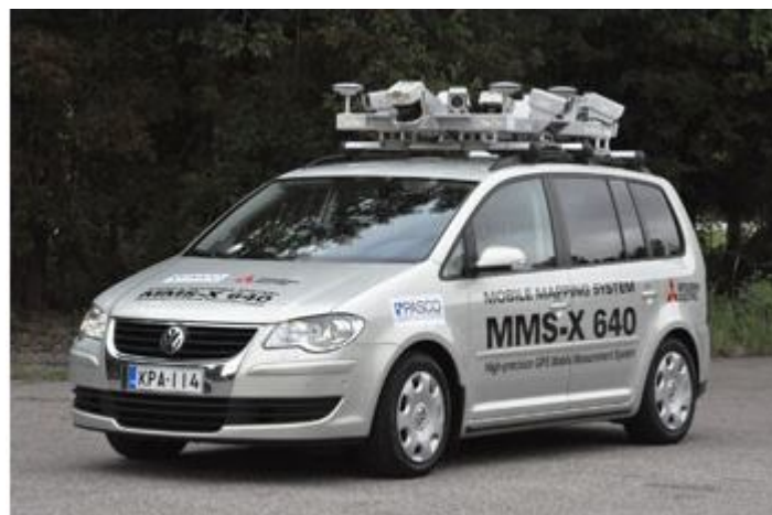
Εικόνα 2.4 : Όχημα με ενσωματωμένο σύστημα laser σάρωσης και δορυφορικού εντοπισμού ( Πηγή : http://www.lidarmap.org )
