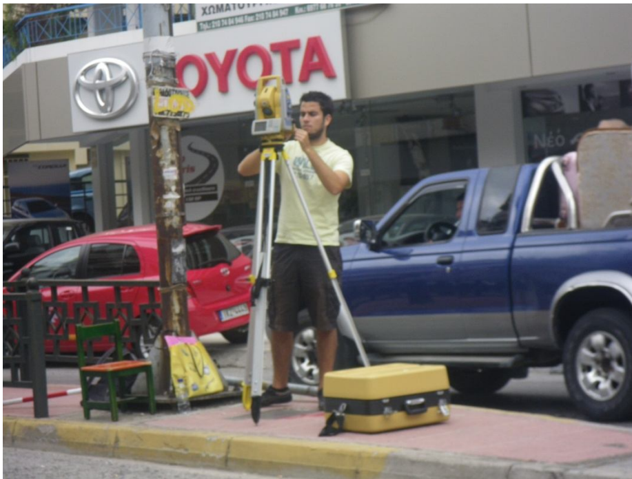
Εικόνα 3.9: Ίδρυση όδευσης με χρήση του γεωδαιτικού σταθμού topcon IS 203
