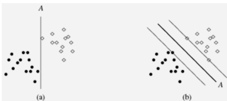
Εικόνα 7 : (a) Ο γραμμικός ταξινομητής διαχωρίζει τα σημεία στο επίπεδο. (b) Στην περίπτωση αυτή, ο γραμμικός ταξινομητής επιτυγχάνει μέγιστο διαχωρισμό (μέγιστο περιθώριο).
