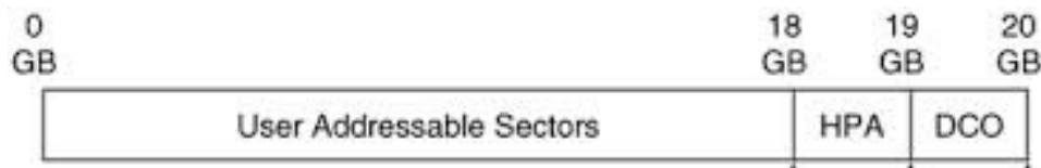
Σχήμα 2.1: Σκληρός δίσκος χωρικότητας 20 GB με HPA 1GB και DCO 1GB
