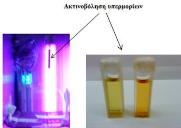
Σχήμα 9.2: Διάταξη ακτινοβολήσης μέσω ενός λαμπτήρα υδραργύρου χαμηλής πίεσης.
