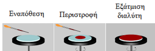
Σχήμα 5.12: Προετοιμασία επικάλυψης με την μέθοδο «spin coating».
