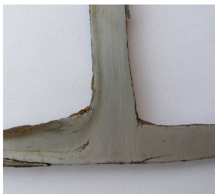
Εικόνα 3.18 Λεπτομέρεια αριστερού ταφ B8. Ευδιάκριτη ανύψωση του ταφ στα αριστερά
