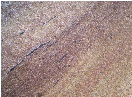
3.89: Λεπτοκρυσταλλικός φερρίτης περλίτης. Εμφανής η διαμόρφωση του συνδέσμου από τον προσανατολισμό των στρωμάτων της σφυρηλασίας.(x100)
