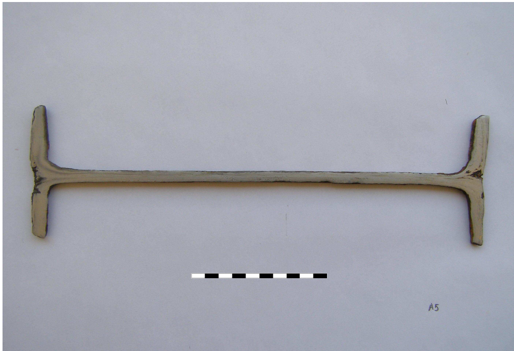
Εικόνα 3.6. Ο σύνδεσμος A5 δείχνει μετά τη λείανση, στίλβωση και προσβολή με nital 10%, ότι δεν διαθέτει συγκόλληση, αλλά είναι ένα μονοκόμματο τεμάχιο μετάλλου, που έχει διαμορφωθεί σε διπλό ταφ. Κλίμακα σε cm
