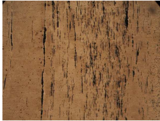
3.63: Η συγκόλληση πολλών στρωμάτων στο στέλεχος. Παρατηρείται μεγάλη διαφορά από την 2331 που είναι διπλά και όμως διαθέτει πολύ περισσότερο άνθρακα.(x50)
