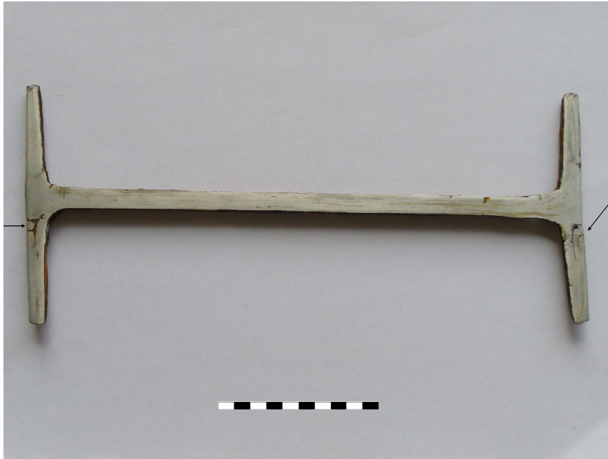
Εικόνα 3.20. Ο σύνδεσμος B9 δείχνει μετά τη διαδικασία της λείανσης, στίλβωσης και προσβολής, ότι και πάλι υπάρχουν μεταλλικές στρώσεις σιδήρου και σκληρού σιδήρου, που θα μελετηθούν αργότερα. Κλίμακα σε cm.
