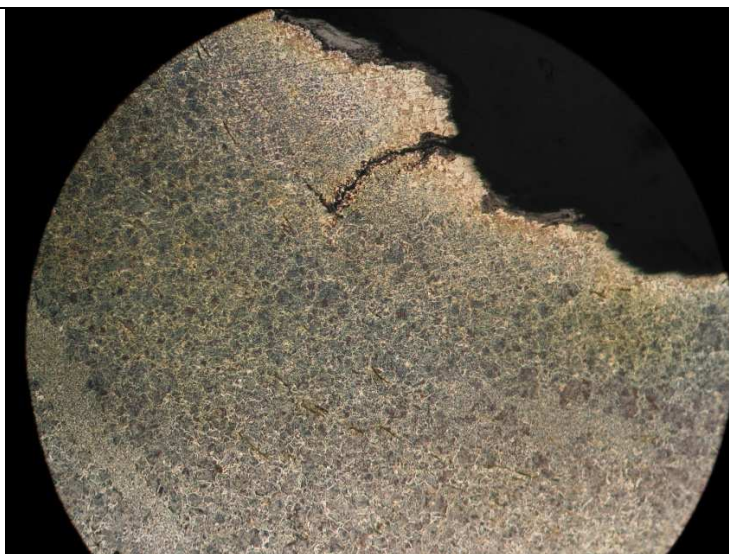
3.69: Παρατηρείται έντονα η παρουσία του άνθρακα, όπου εμφανίζεται με τη μορφή του σορμπίτη και όχι του περλίτη μαζί με φερρίτη. Αυτό ισχύει γιατί ο σορμπίτης εμφανίζεται με ανάγλυφη κοκκώδη δομή και όχι υπό τη μορφή στρωμάτων.(x50)
