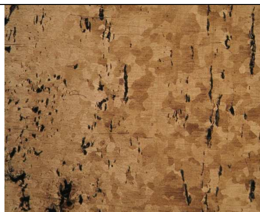
3.107 Φερριτική δομή. Φαίνονται καθαρά τα εγκλείσματα και η κατεύθυνσή τους. (x50)
