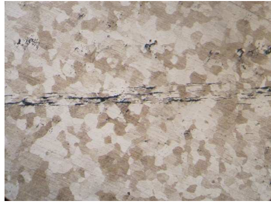
3.100: Φερρίτης και στρώματα σφυρηλασίας.(x50)
