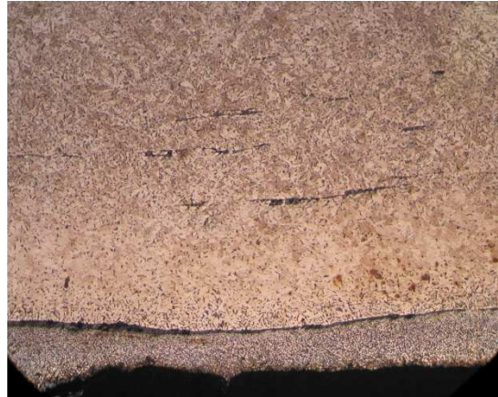
3.87: Εξωτερικά του άκρου φερρίτης με λίγο περλίτη και καθώς προχωρούμε προς το εσωτερικό του παρατηρείται αύξηση του περλίτη.(x50)
