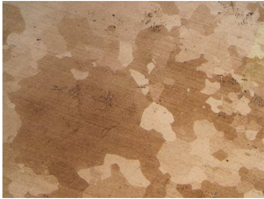
3.99: Φερρίτης με κόκκους αρκετά μεγάλου μεγέθους.(x50)
