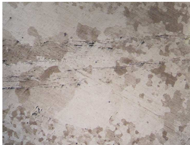
3.101: Κόκκοι φερρίτη διαφορετικής διάστασης.(x50)
