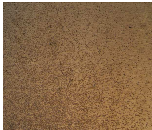
3.81: Φερρίτης με περλίτη- λεπτοκρυσταλλική δομή. (x50)
