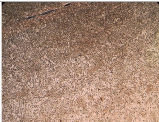
3.93: Στο άνω τμήμα παρατηρείται περλίτης ο οποίος καθώς προχωρούμε προς το κάτω τμήμα λιγοστεύει μέχρι που καταλήγει σε περλίτη στα όρια των κόκκων του φερρίτη.(x50)
