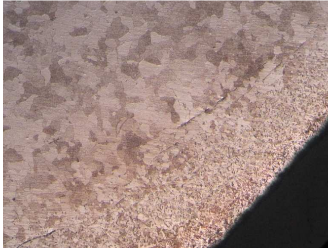
3.74: Εξωτερικά βλέπουμε λίγο περλίτη στα όρια των κόκκων του φερρίτη και καθώς προχωρούμε στο εσωτερικό του συνδέσμου έχουμε μόνο φερρίτη.
