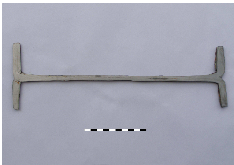
Εικόνα 3.11. Δείχνει τον σύνδεσμο B4 μετά την λείανση, στίλβωση και προσβολή με nital 10%.Κλίμακα σε cm.
