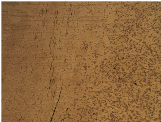
3.72: Στο λαιμό του συνδέσμου παρατηρείται φερριτοπερλιτική δομή και η κατεύθυνση των στρωμάτων της σφυρηλασίας.(x50)
