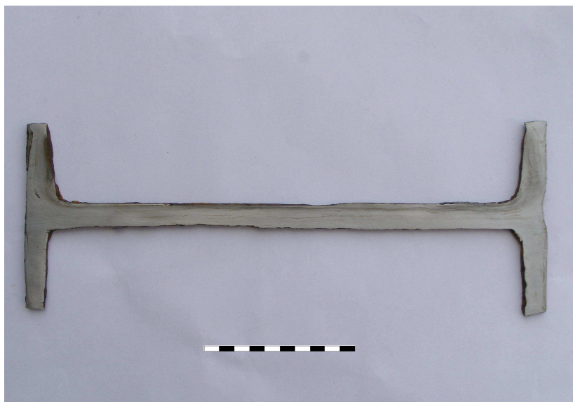
Εικόνα 3.16. Η προσβολή μετά την γνωστή ετοιμασία της επιφανείας τους συνδέσμου B8 και την προσβολή με το γνωστό αντιδραστήριο, έδειξε σαφώς, ότι αποτελείται από στρώσεις μαλακού σιδήρου και σκληρού χάλυβα. Κλίμακα σε cm
