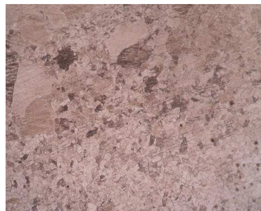
3.39 Ανομοιογένεια του μεγέθους των κόκκων του φερρίτη.(x50)
