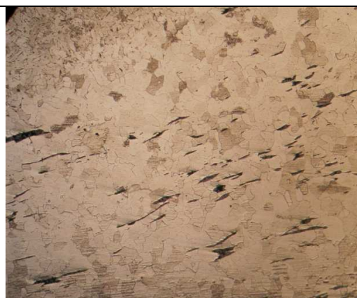
3.110: Φαίνεται ότι ο σύνδεσμος δεν έχει υποστεί αναδίπλωση όπως θεωρήθηκε κατά τη μακροσκοπική του μελέτη. (x50)
