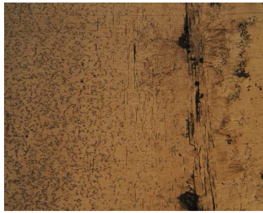
3.73: Φαίνεται προχωρημένη διάβρωση μεταξύ των στρωμάτων της σφυρηλασίας. Η δομή είναι φερριτοπερλιτική.(x50)
