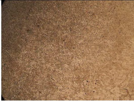
3.91: Φερρίτης από τη μία πλευρά ο οποίος αποκτά καθώς προχωρούμε αριστερά όλο και περισσότερο άνθρακα σχηματίζοντας περλίτη. Κεντρικά έχουμε φερρίτη με περλίτη στα όρια των κόκκων του φερρίτη.(X50)
