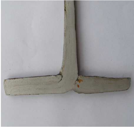
Εικόνες .3.12 , 3.13 Αριστερό ταφ του συνδέσμου B4 και λεπτομέρεια αριστερού ταφ B4
