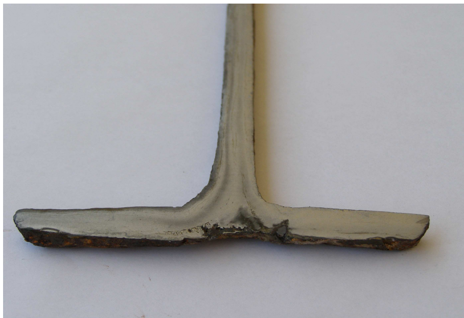
Εικόνα 3.7.Αριστερό ταφ του συνδέσμου A5
