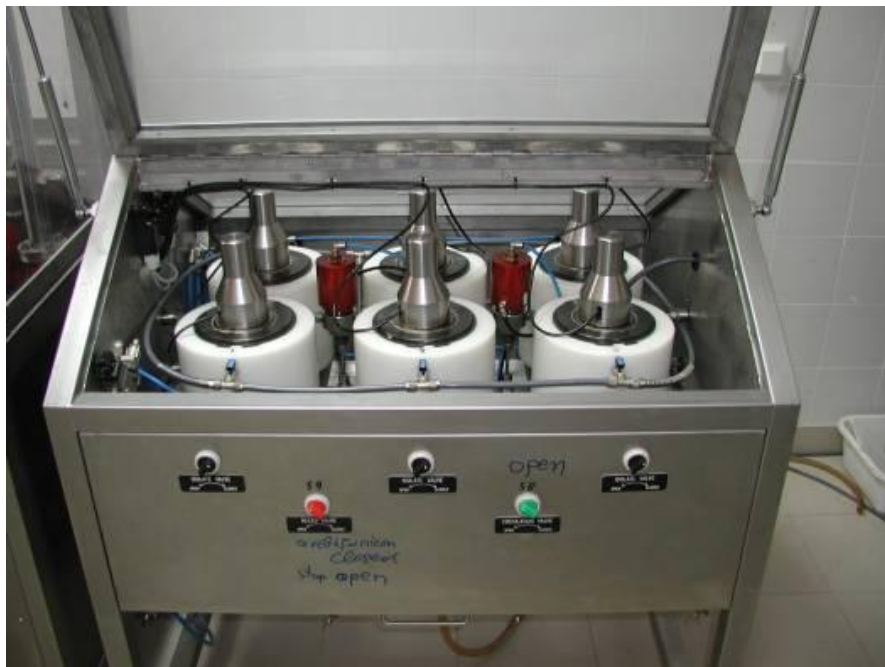
Εικόνα 2.2. Λεπτομερής άποψη της μονάδας με τα 6 κελιά ΥΥΠ των 42 mL το καθένα, που χρησιμοποιείται για κινητικές μελέτες.
