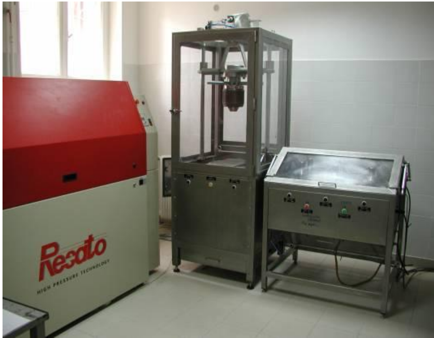
Εικόνα 2.1. Γενική άποψη του Εργαστηρίου Υπερηψηλής Πίεσης και της μονάδας ΥΥΠ. Στο κέντρο διακρίνεται η μονάδα για την επεξεργασία τροφίμων όγκου μέχρι 1,5L και στα δεξιά η μονάδα με τα 6 κελιά ΥΥΠ των 42mL έκαστο.
