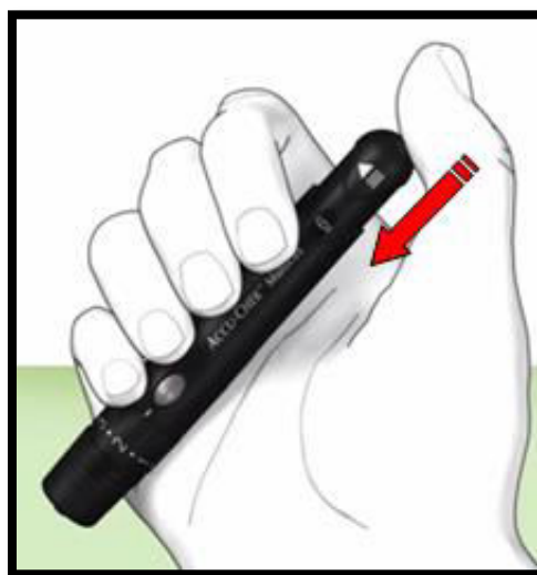
Εικόνα IV.48 Οπλισμός στυλό τρυπήματος με πίεση εμβόλου
