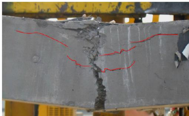
Εικόνα 4.13 Αστοχία καμπτόμενης δοκού και εμφάνιση σφηνών σύνθλιψης, [Haskett et al 2009].
